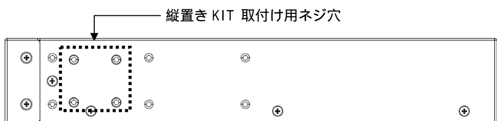
図 3-5 ApresiaNP2000-24T4X、ApresiaNP2000-48T4X 縦置き KIT 取り付けネジ穴位置
