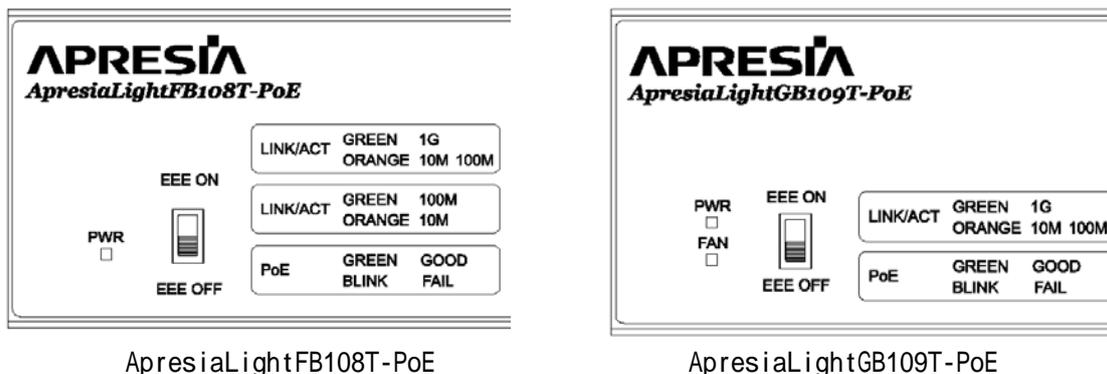
図 6-1 装置のディップスイッチ部分
