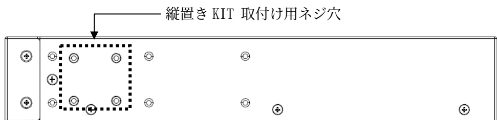
図 3-14 ApresiaNP3000-24T8X4Q、ApresiaNP2100-24T4X、ApresiaNP2100-48T4X、ApresiaNP2000-24T4X、ApresiaNP2000-48T4X 縦置き KIT 取り付けネジ穴位置
