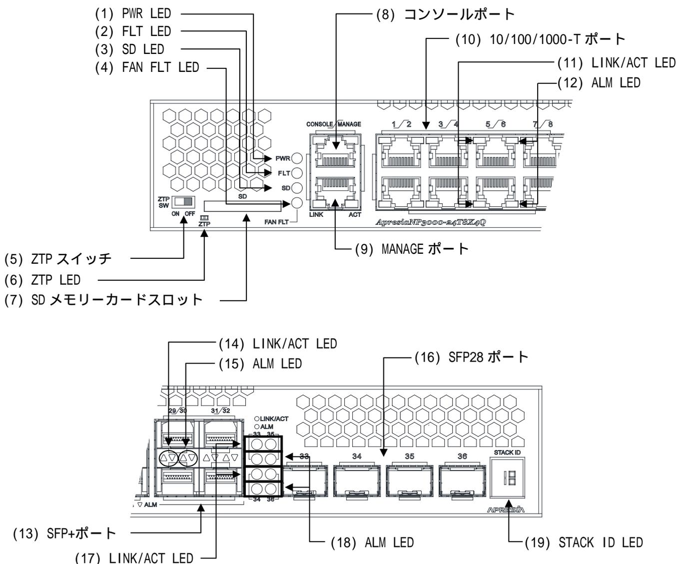
図 2-6 ApresiaNP3000-24T8X4Q フロントパネルの構成
