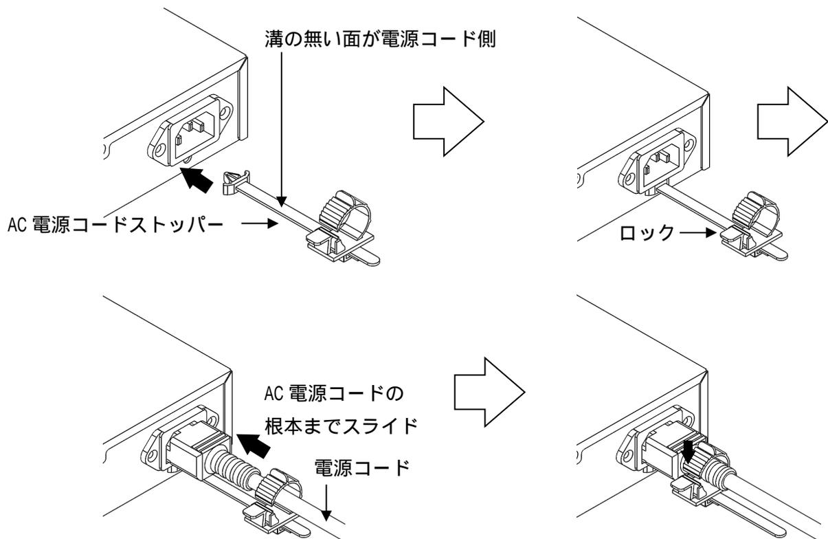
図 3-29 AC 電源コード、AC 電源コードストッパーの接続
