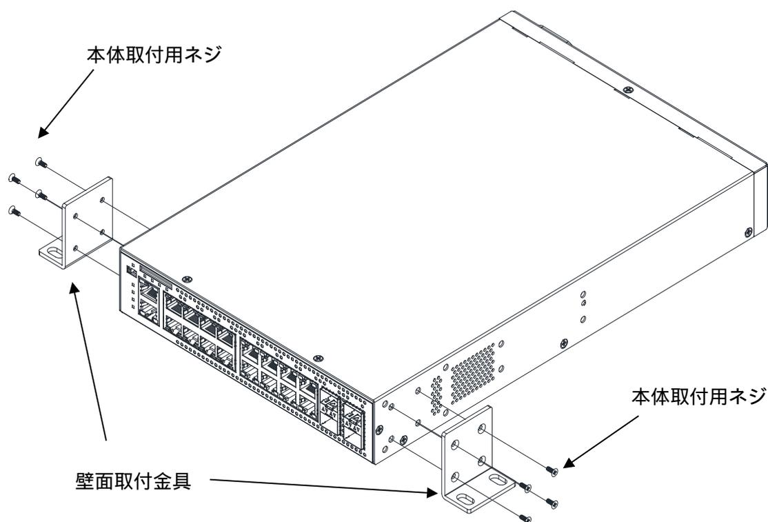
図 3-16 壁面取付金具(AL-WM)の取り付け方法
