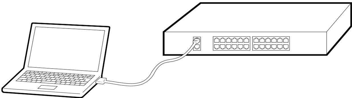
図 4-2 RS-232C ケーブルの接続
