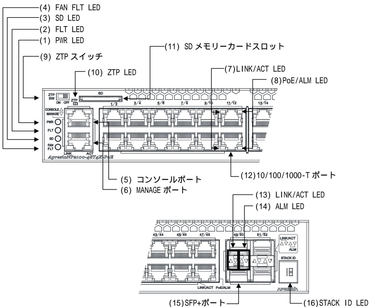
図 2-12 ApresiaNP2100-48T4X-PoE フロントパネルの構成
