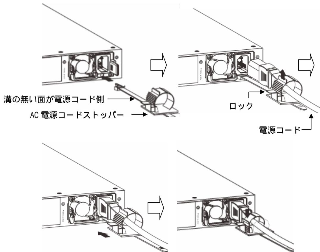
図 3-28 AC 電源コード、AC 電源コードストッパーの接続
