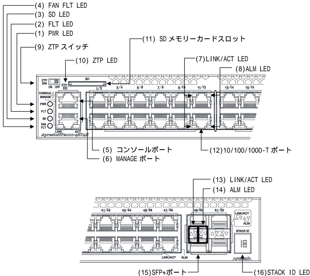
図 2-11 ApresiaNP2100-48T4X フロントパネルの構成
