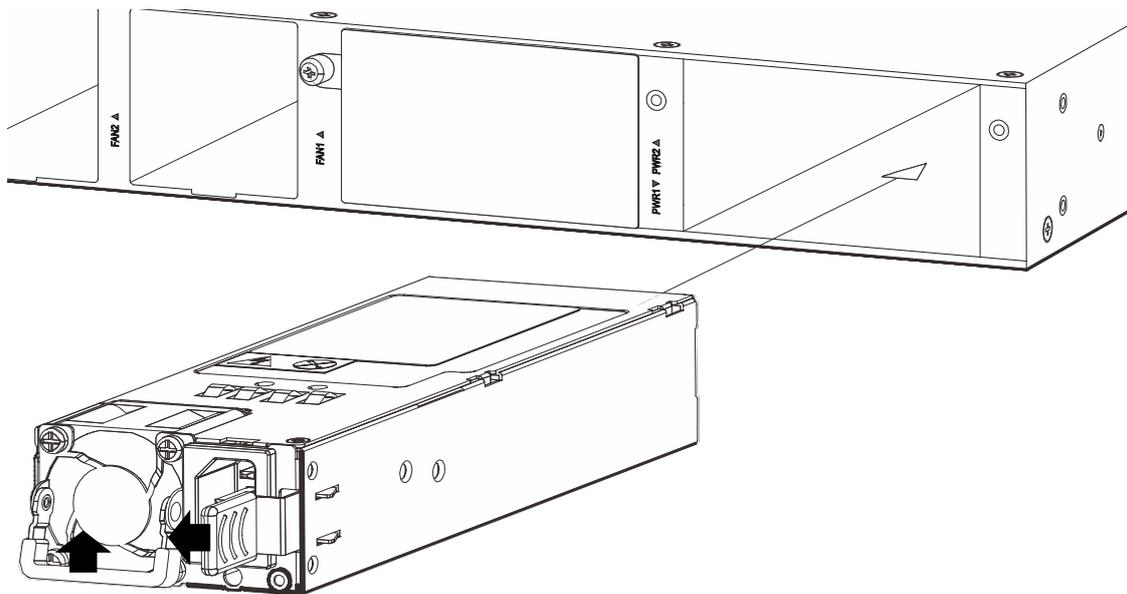
図 3-26 電源ユニットの装着方法
