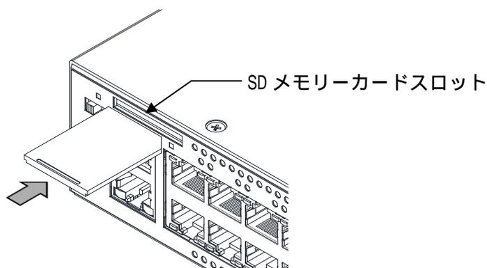
図 3-32 SD メモリーカード挿入方向
