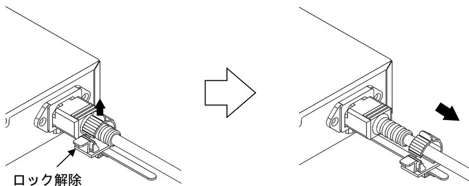
図 3-30 AC 電源コードの抜き取り
