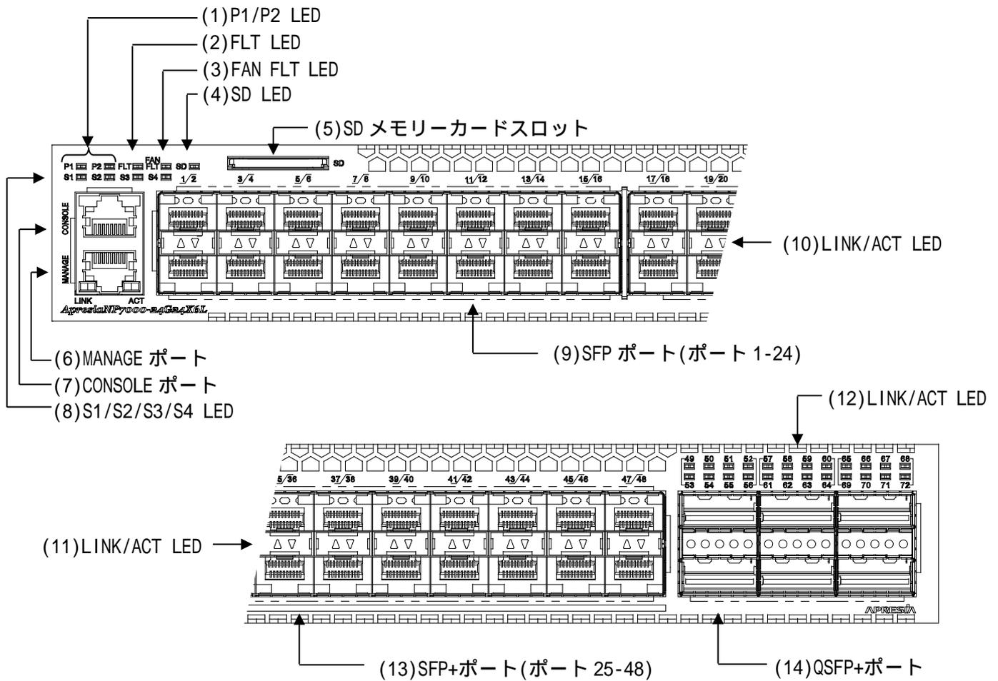
図 2-2 ApresiaNP7000-24G24X6L フロントパネルの構成
