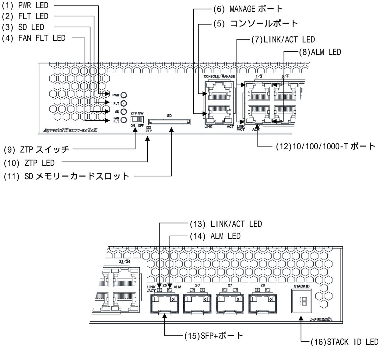
図 2-9 ApresiaNP2100-24T4X フロントパネルの構成
