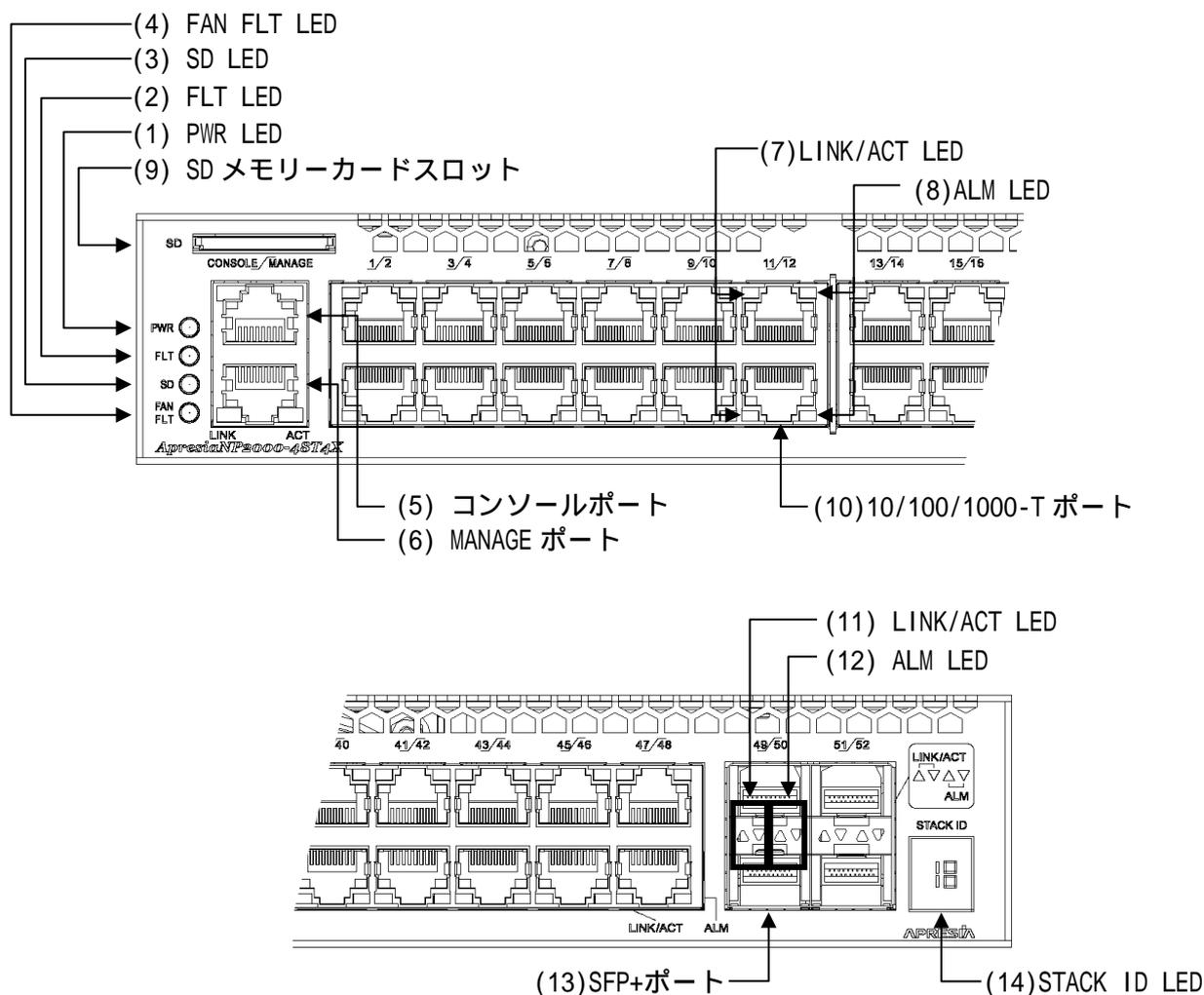
図 2-15 ApresiaNP2000-48T4X フロントパネルの構成
