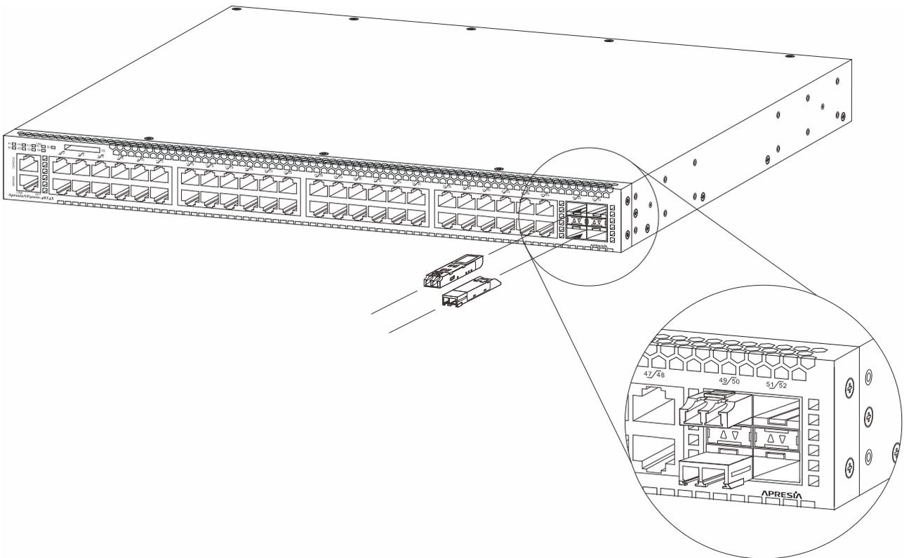
図 3-20 ApresiaNP5000-48T4X、ApresiaNP4000-20Xt4X、ApresiaNP3000-24X4Q、ApresiaNP3000-24T8X4Q、ApresiaNP2500-8MT4X-PoE、ApresiaNP2500-16MT4X-PoE、ApresiaNP2100-48T4X、ApresiaNP2100-48T4X-PoE、ApresiaNP2000-48T4X、ApresiaNP2000-48T4X-PoE SFP、SFP+挿入向き
