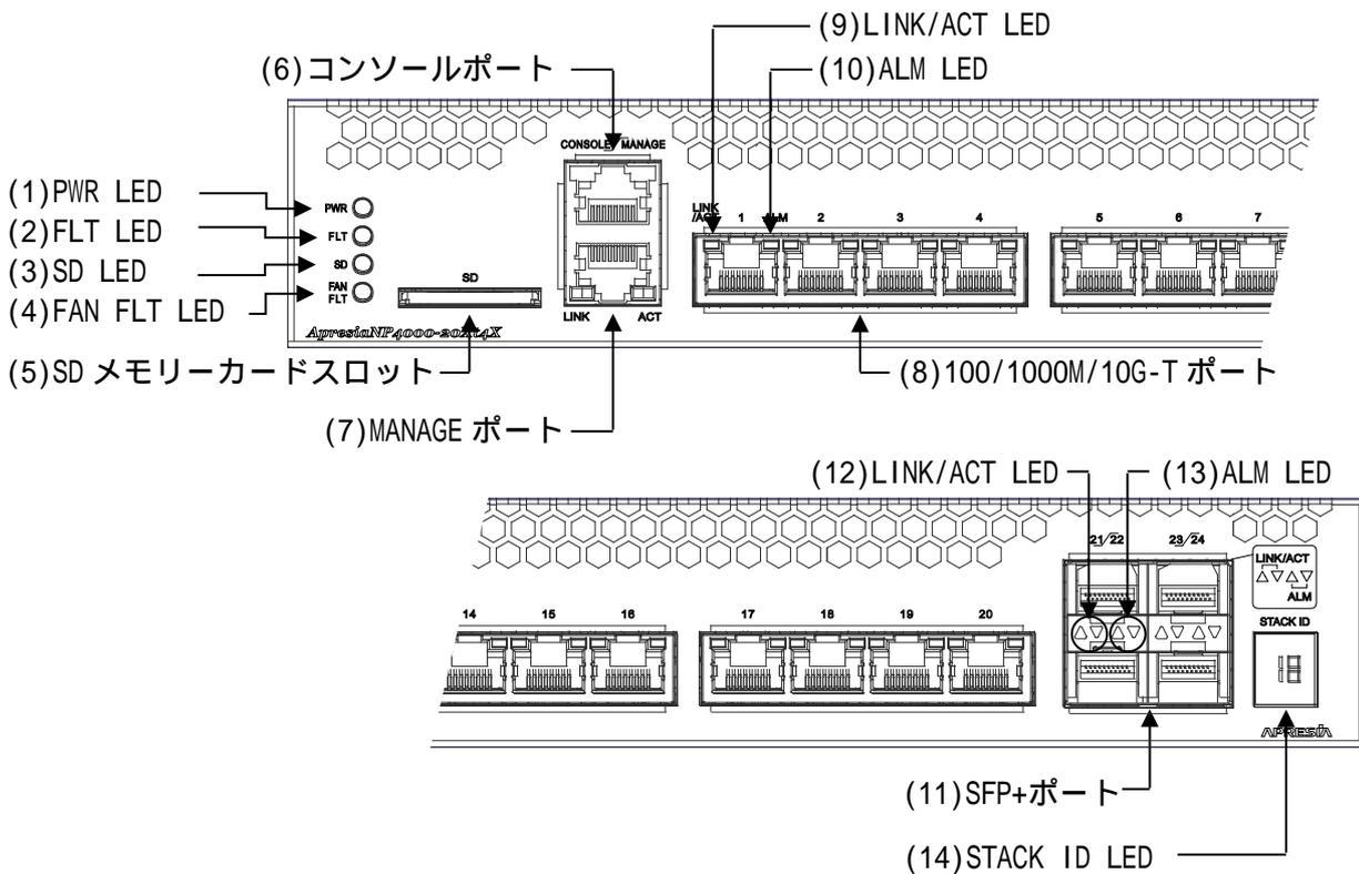
図 2-4 ApresiaNP4000-20Xt4X フロントパネルの構成
