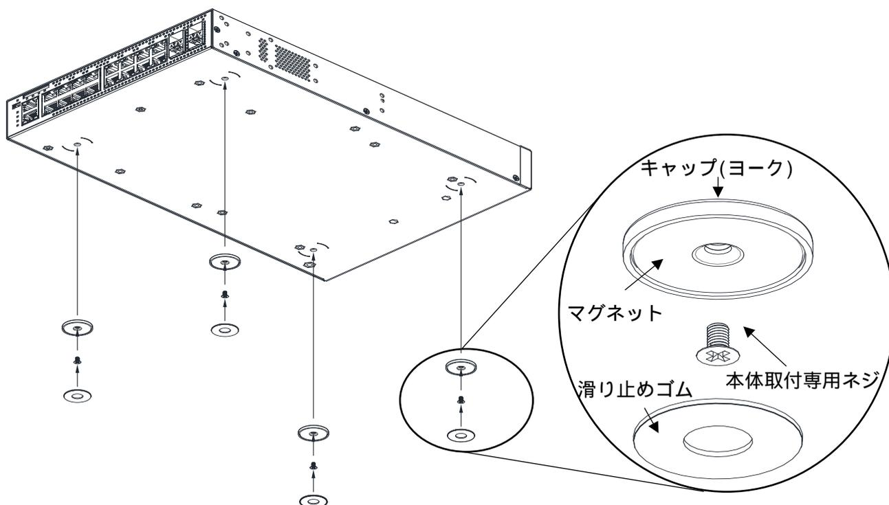
図 3-15 マグネット(AL-MG-B04)の取り付け方法
