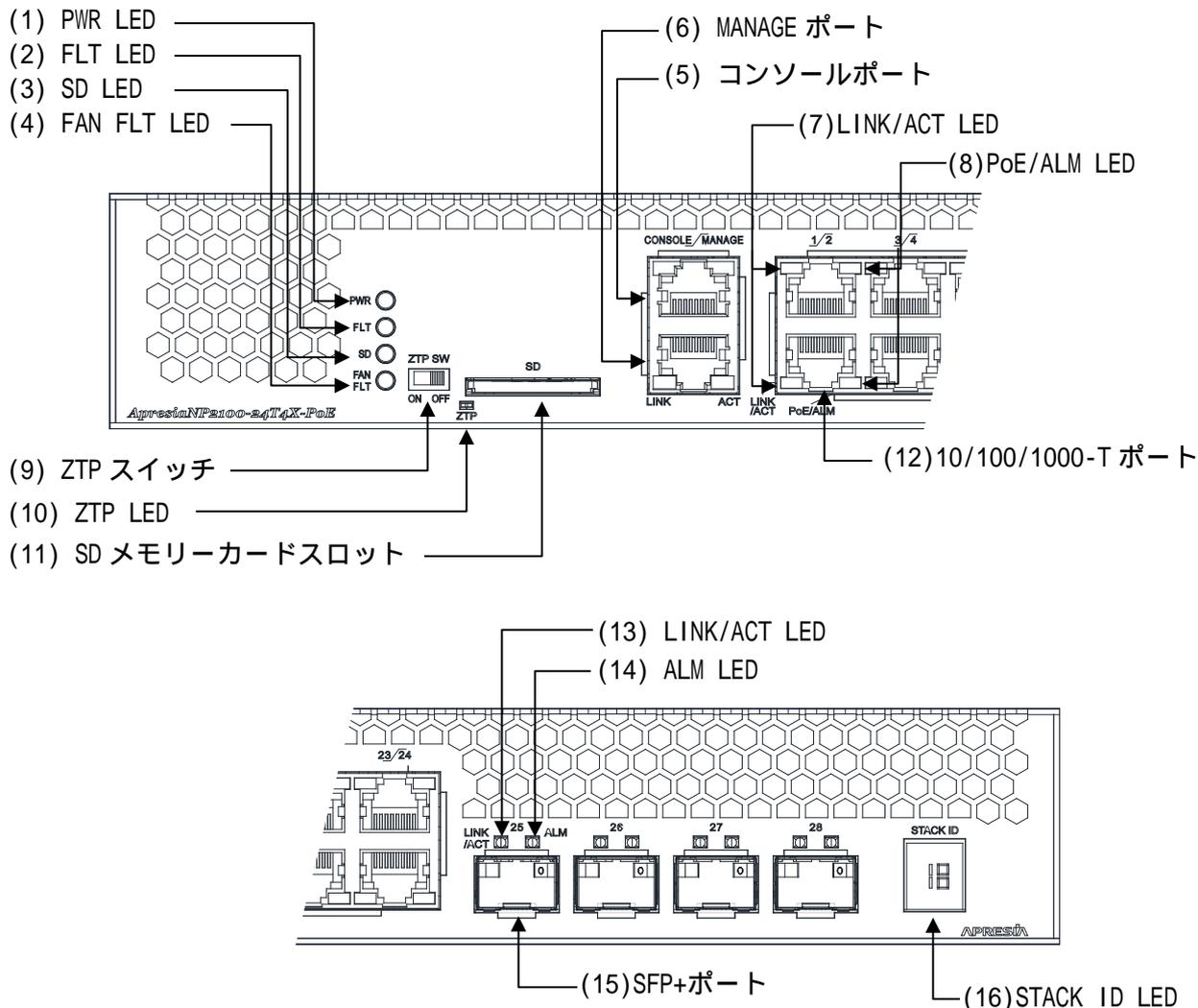
図 2-10 ApresiaNP2100-24T4X-PoE フロントパネルの構成
