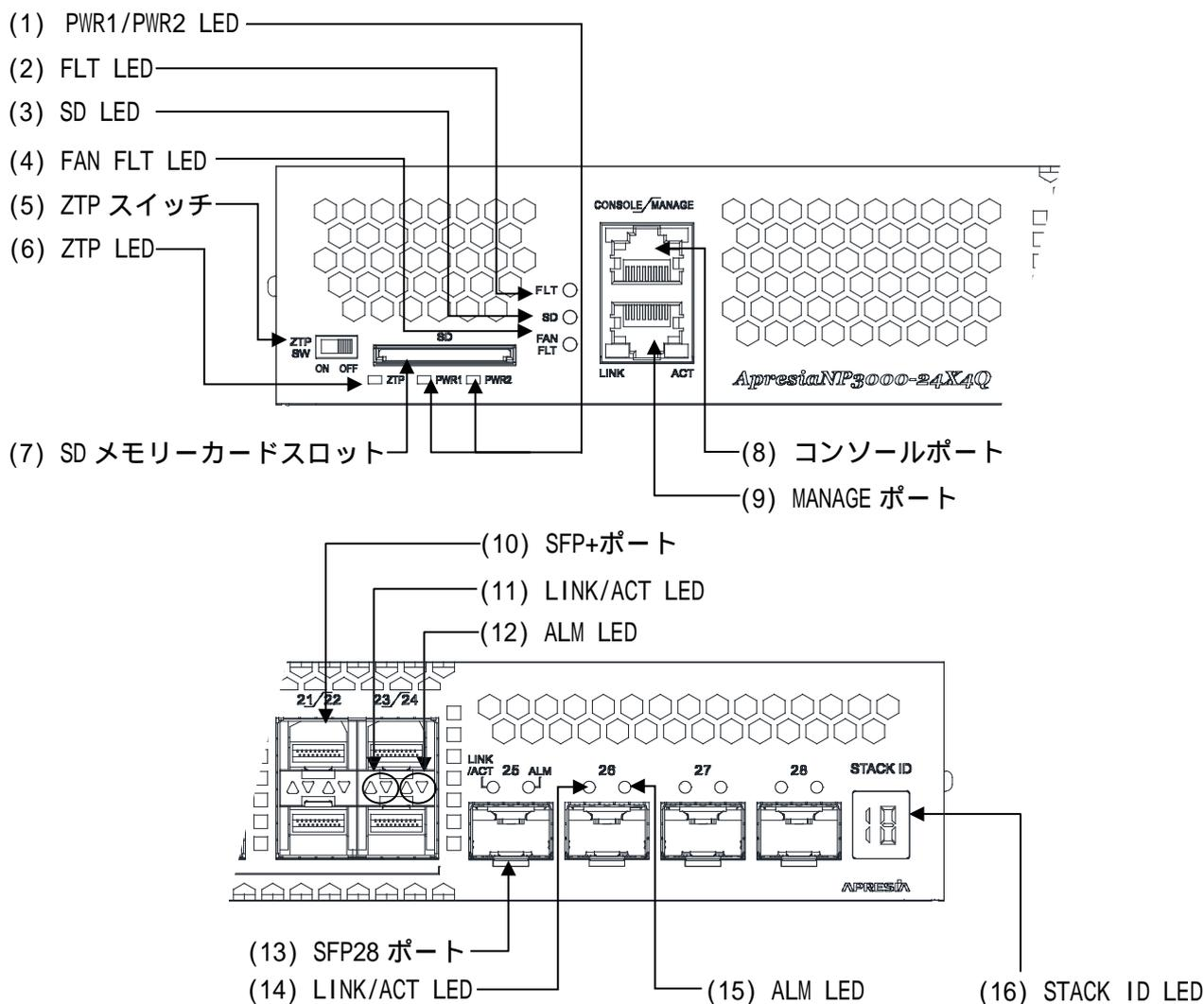
図 2-5 ApresiaNP3000-24X4Q フロントパネルの構成
