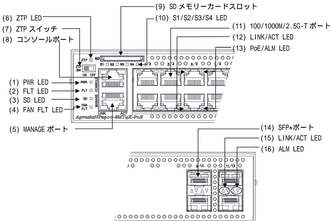
図 2-7 ApresiaNP2500-8MT4X-PoE フロントパネルの構成
