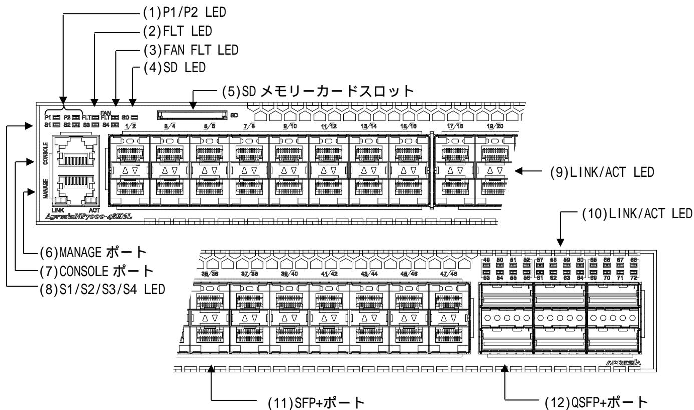
図 2-1 ApresiaNP7000-48X6L フロントパネルの構成
