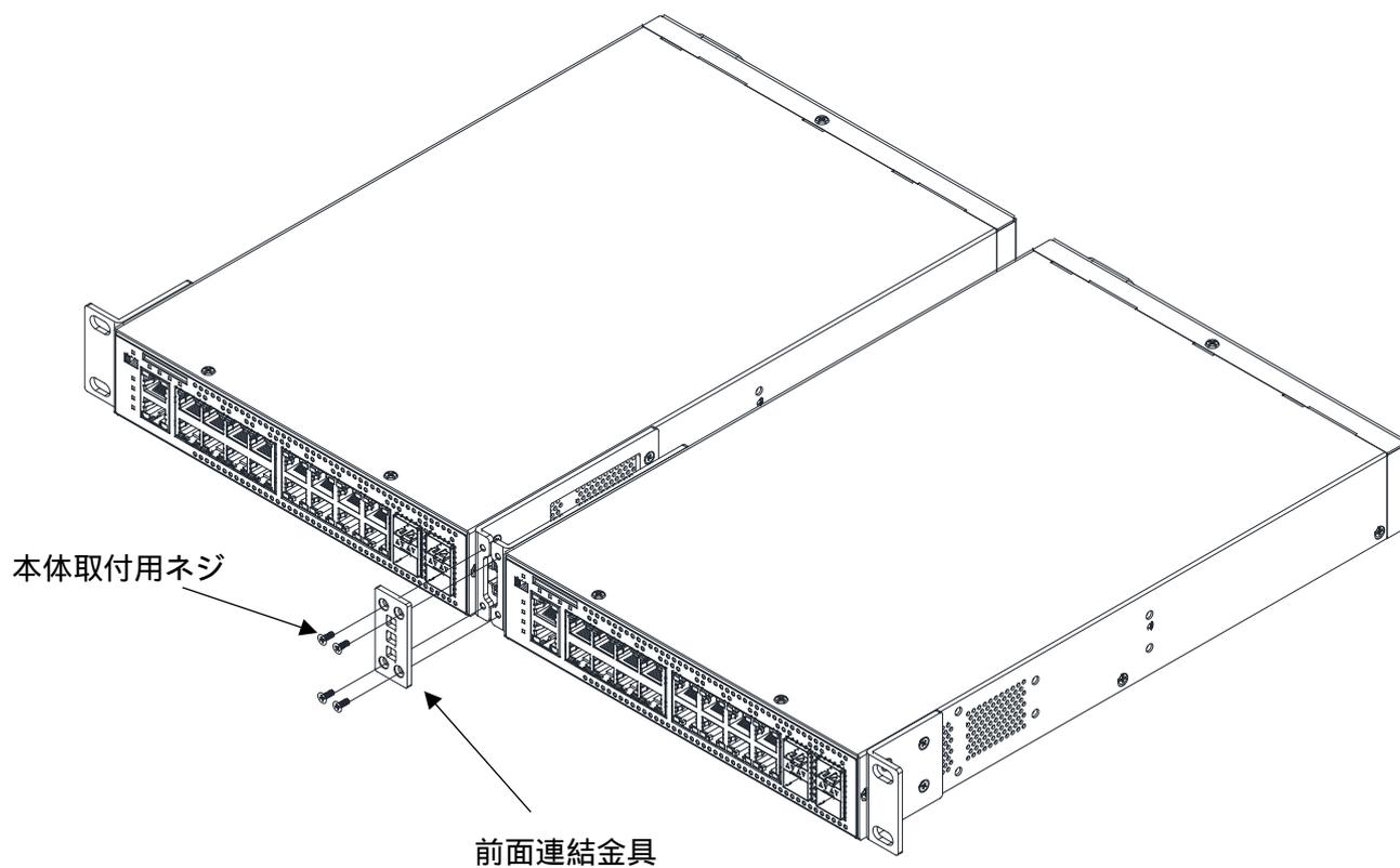
図 3-10 専用ラックマウント金具(2台連結用)ALN-2P-RM01 の取り付け方法
