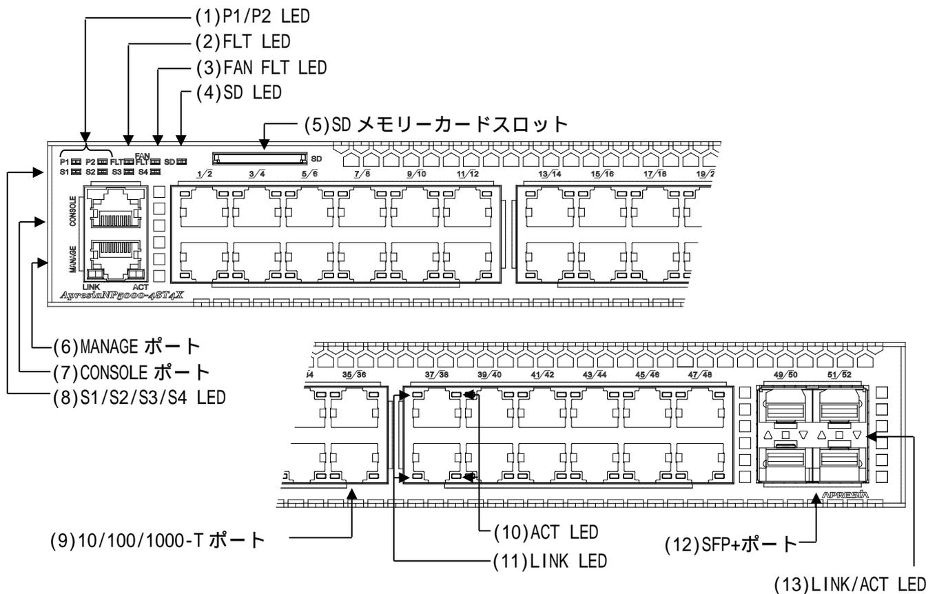
図 2-3 ApresiaNP5000-48T4X フロントパネルの構成
