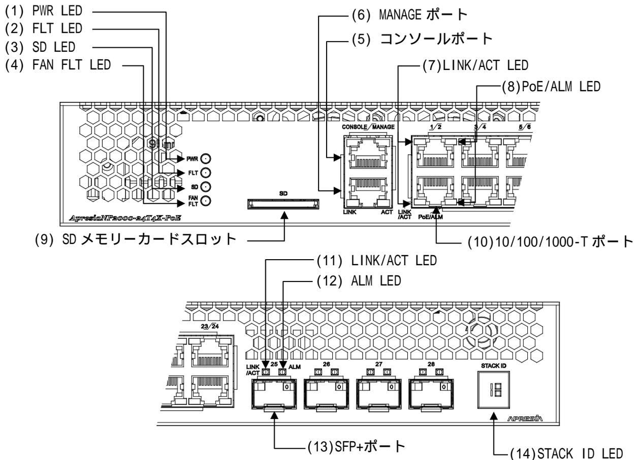
図 2-14 ApresiaNP2000-24T4X-PoE フロントパネルの構成
