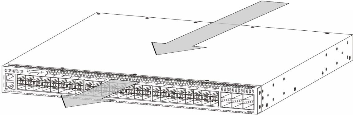
图 3-4 ApresiaNP7000-48X6L (背面吸气前面排气)、ApresiaNP7000-24G24X6L (背面吸气前面排气)、
