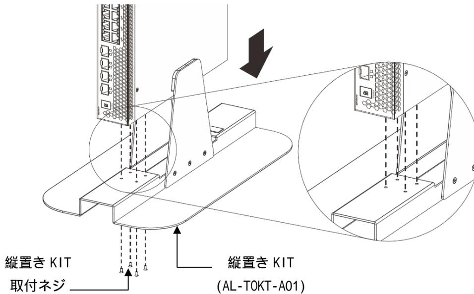
図 3-12 縦置き KIT(AL-TOKT-A01)の取り付け方法
