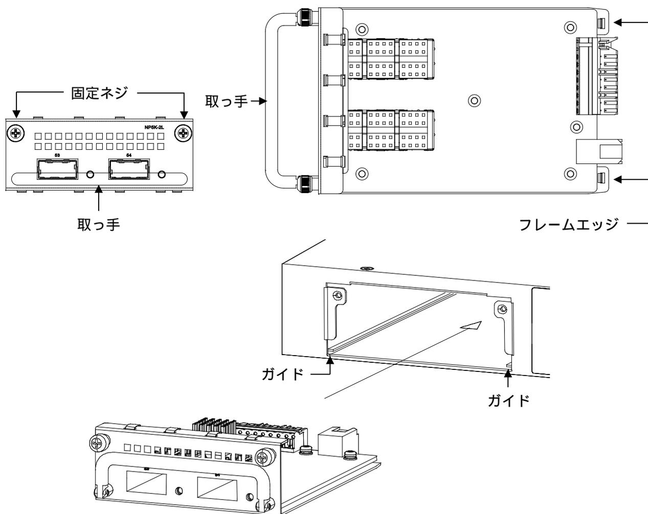
図 3-17 インターフェースモジュールの装着方法
