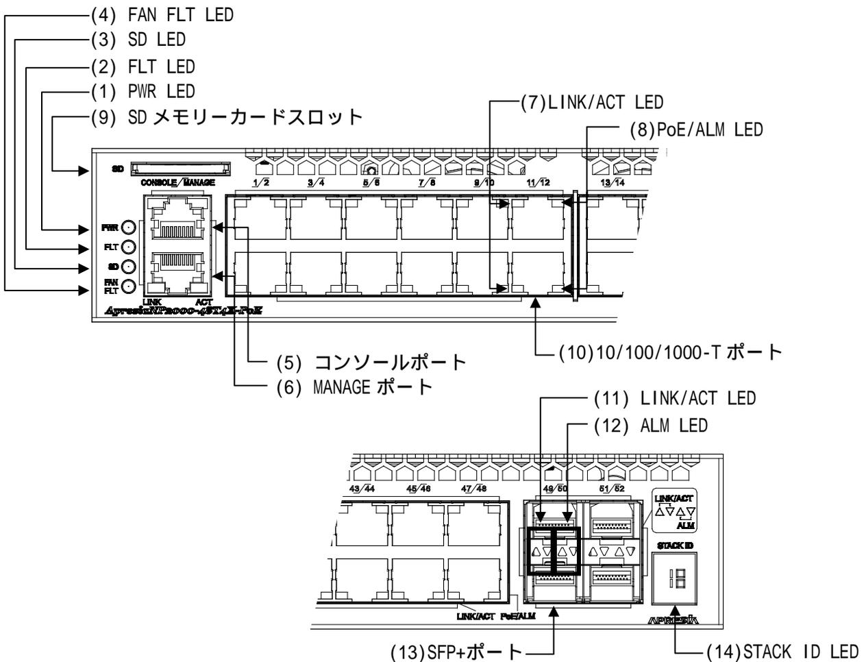
図 2-16 ApresiaNP2000-48T4X-PoE フロントパネルの構成
