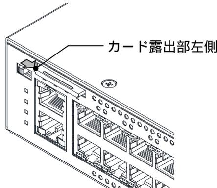
図 3-33 SD メモリーカード抜去方法補足
