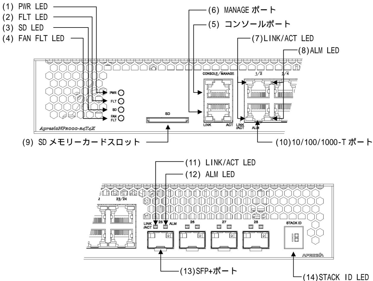
図 2-13 ApresiaNP2000-24T4X フロントパネルの構成
