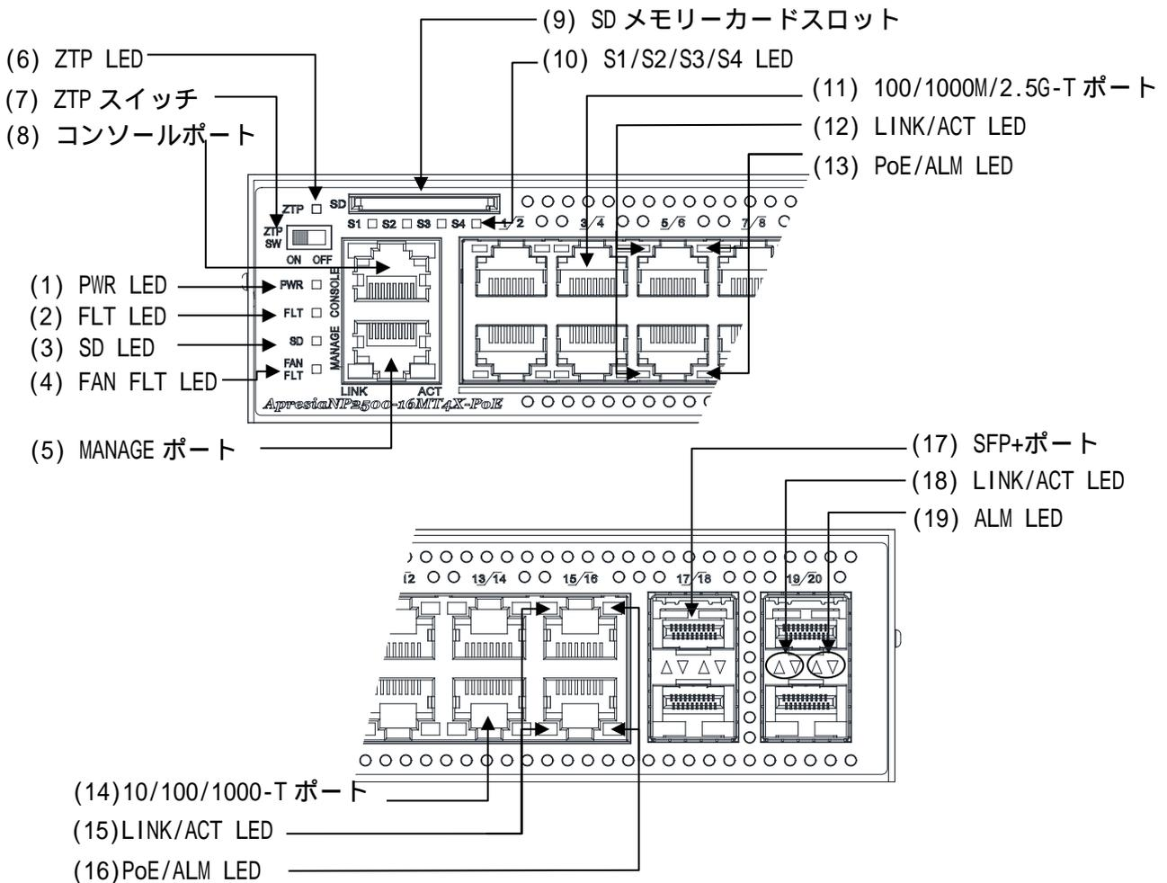
図 2-8 ApresiaNP2500-16MT4X-PoE フロントパネルの構成
