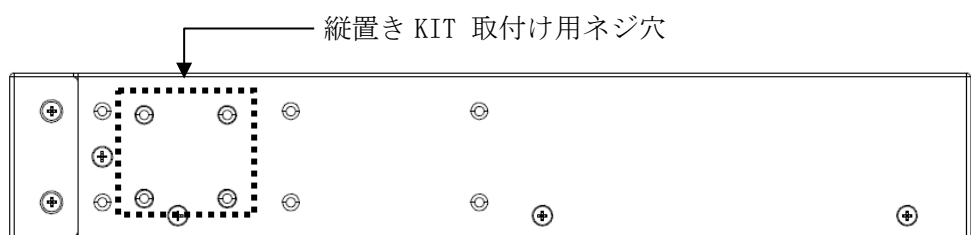
図 3-8 ApresiaNP2000-24T4X、ApresiaNP2000-48T4X 縦置き KIT 取り付けネジ穴位置
