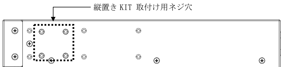
図 3-12 ApresiaNP3000-24T8X4Q、ApresiaNP2100-24T4X、ApresiaNP2100-48T4X、ApresiaNP2000-24T4X、ApresiaNP2000-48T4X 縦置き KIT 取り付けネジ穴位置
