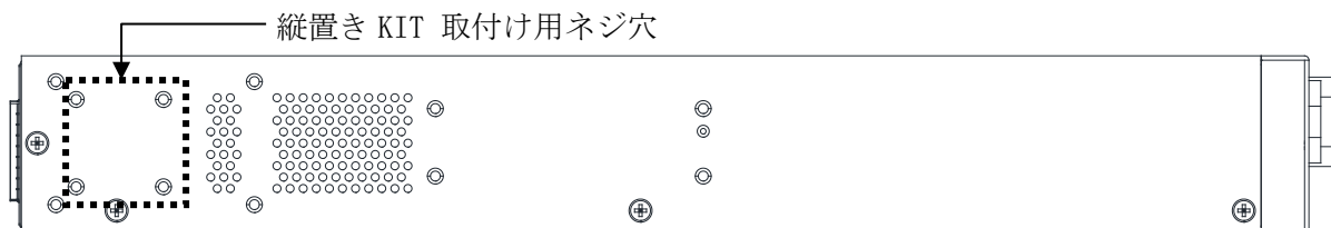
図 3-11 ApresiaNP2500-8MT4X-PoE、ApresiaNP2500-48T4X-PoE 縦置き KIT 取り付けネジ穴位置
