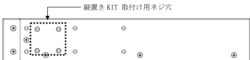
図 3-12 ApresiaNP3000-24T8X4Q、ApresiaNP2100-24T4X、ApresiaNP2100-48T4X、ApresiaNP2000-24T4X、ApresiaNP2000-48T4X 縦置き KIT 取り付けネジ穴位置
