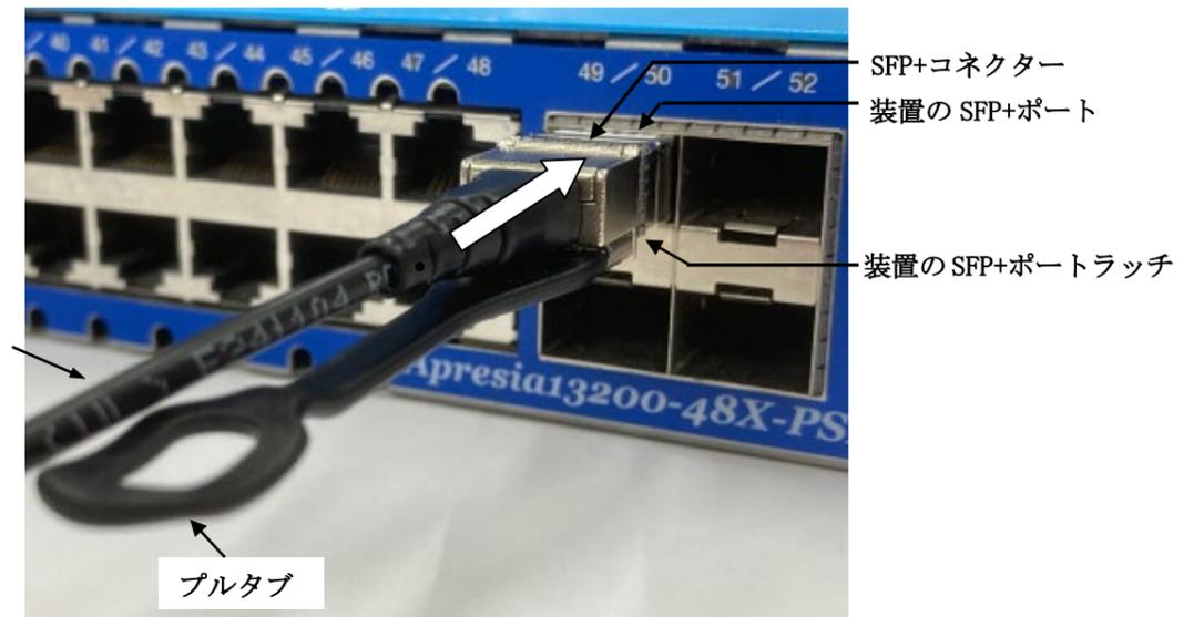
(製品型式 H-SFP+AOCxM、表示型式 FCBG110SD1CxM の例)
