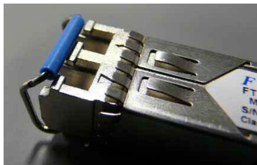
レバーが完全に上がっていない状態
