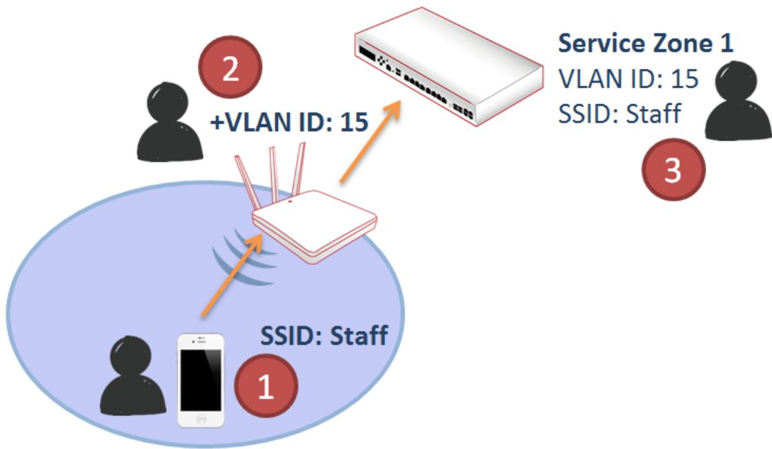
図に示すように、会社のスタッフは、アクセスポイントによる特定の SSID ブロードキャストに関連付けられています。この SSID は、VLAN ID 15 の VAP に属するとします。したがって、コントローラに転送された AP のトラフィックは、スタッフアクセス用の設定を使用してサービスゾーン 1 にマッピングされます。
