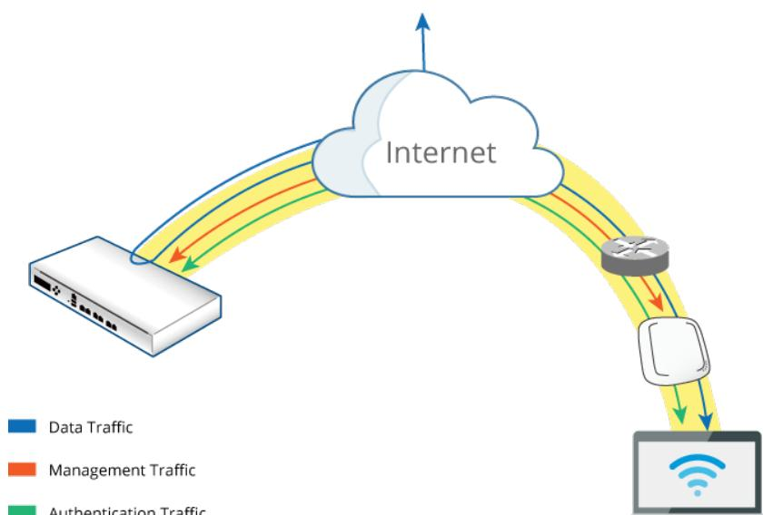
スプリットトンネルの場合、ユーザー認証に関するトラフィックだけがコントローラに送り
