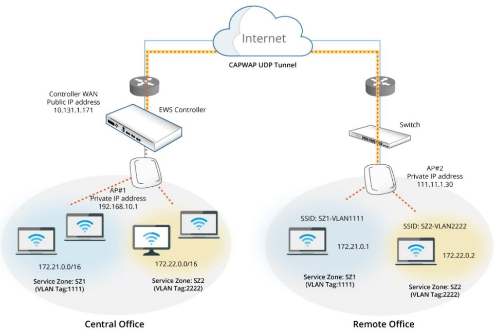
完全なトンネルは CAPWAP プロトコルを使用してアクセスポイントと通信します。これにより、提供されるサービスエリア AP からのすべての管理トラフィック、認証トラフィック、およびデータトラフィックが、データトラフィックをインターネットに転送する前に、コントローラに転送されます。EWS コントローラは、レイヤ 3 ネットワーク上で役割ベースのポリシーを実装でき、リモートサイトでユーザーアクセス制御を利用できます。この機能により、Edgecore EWS コントローラは、一元化された AP 管理とユーザー管理を完全にサポートできます。
