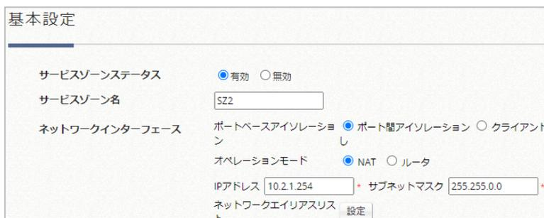
The screenshot shows the '基本設定' (Basic Settings) page. 'サービスゾーンステータス' (Service Zone Status) is set to '有効' (Enabled). 'サービスゾーン名' (Service Zone Name) is 'SZ2'. Under 'ネットワークインターフェース' (Network Interface), 'ポートベースアイソレーション' (Port-based isolation) is selected. 'オペレーションモード' (Operation Mode) is set to 'NAT'. IP settings are: IPアドレス (IP Address) 10.2.1.254 and サブネットマスク (Subnet Mask) 255.255.0.0. A '設定' (Settings) button is at the bottom right.
