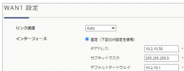
The screenshot shows the 'WAN1 設定' (WAN1 Settings) page. It includes a 'リンク速度' (Link Speed) dropdown set to 'Auto'. Under 'インターフェース' (Interface), the '固定 (下記のIP設定を使用)' (Fixed (Use the following IP settings)) option is selected. The IP settings are: IPアドレス (IP Address) 10.2.10.50, サブネットマスク (Subnet Mask) 255.255.255.0, and デフォルトゲートウェイ (Default Gateway) 10.2.10.1.
