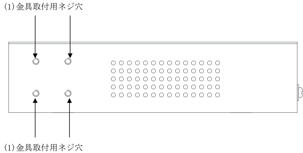
図 2-14 ApresiaLightGC124-SS のサイドパネルの構成
