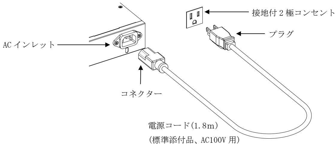
図 3-22 AC 電源の接続方法
