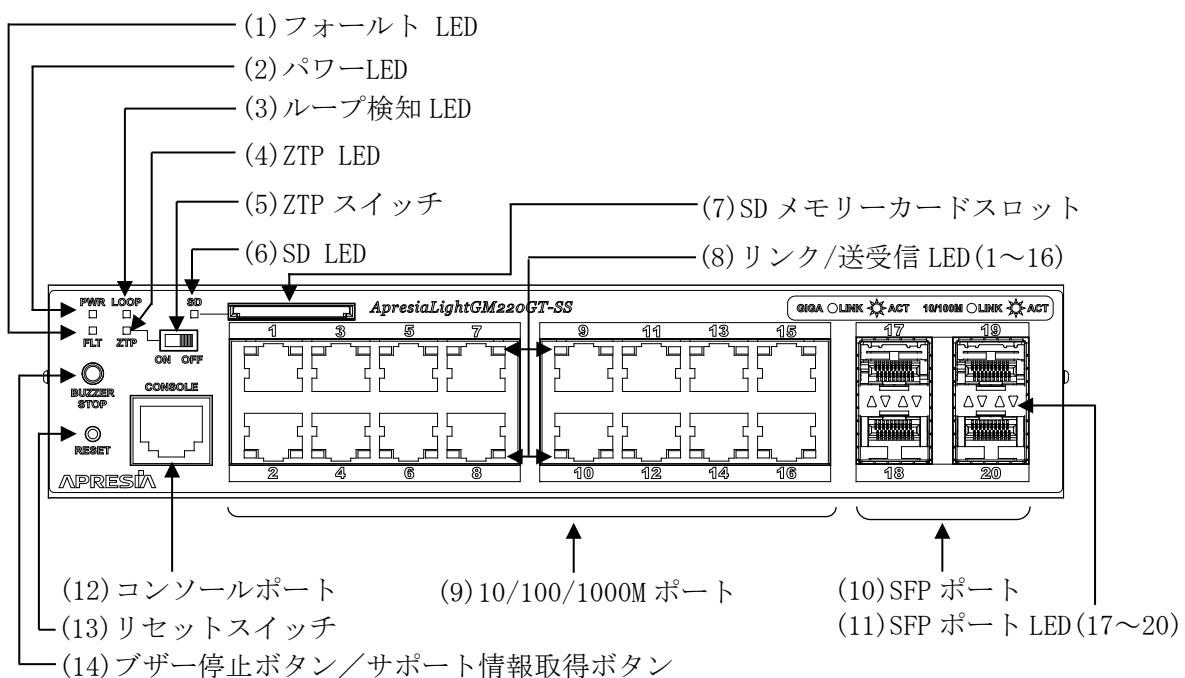
図 2-6 ApresiaLightGM220GT-SS のフロントパネルの構成
