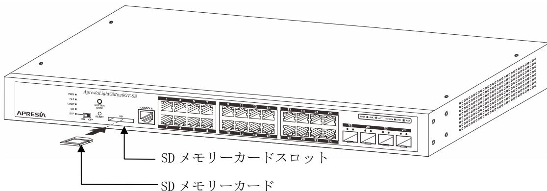
図 3-21 SDメモリーカードの挿抜方法
