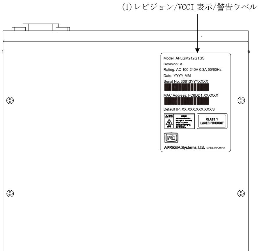
図 2-3 ApresiaLightGM212GT-SS のトップパネルの構成
