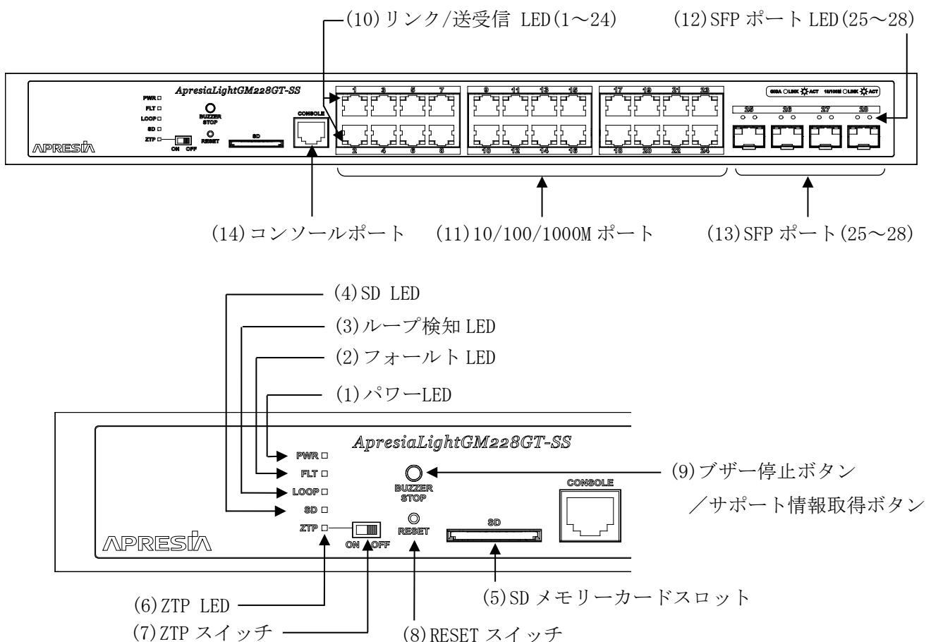
図 2-11 ApresiaLightGM228GT-SS のフロントパネルの構成
