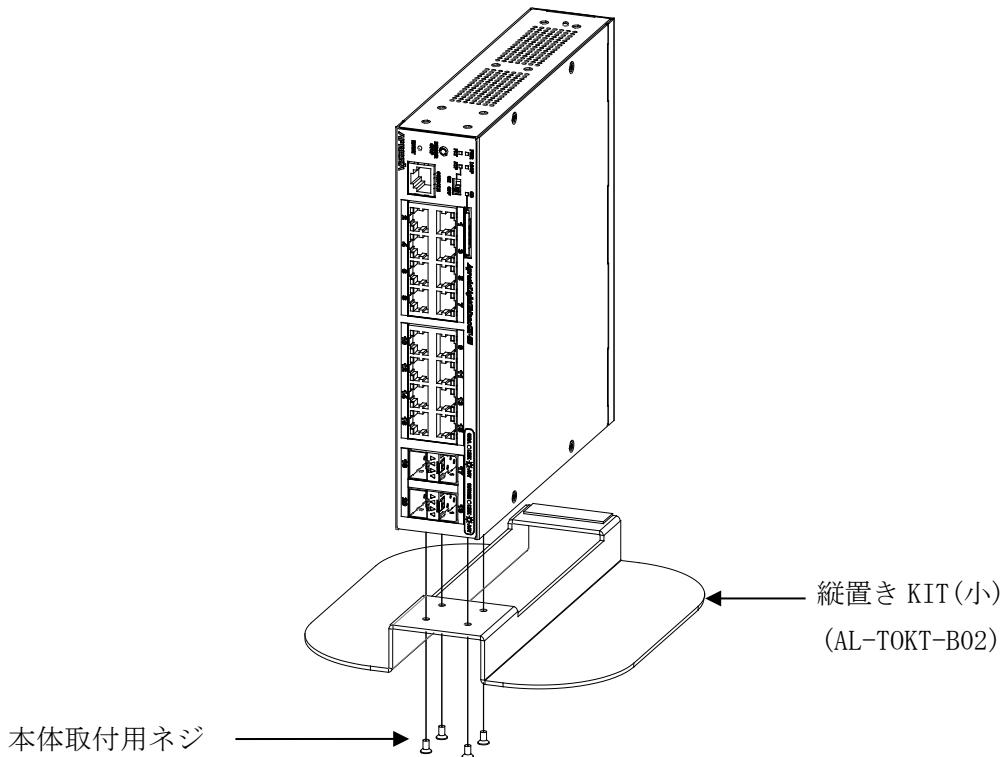
図 3-20 縦置き KIT(小) (AL-TOKT-B02) の取り付け方法
