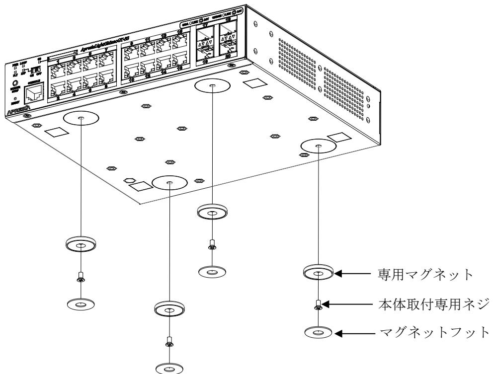
図 3-14 専用マグネットの取り付け方法
