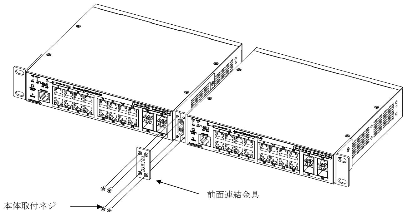
図 3-17 ラックマウント金具(2台連結用) (ALN-2P-RM01)の取り付け方法 4
