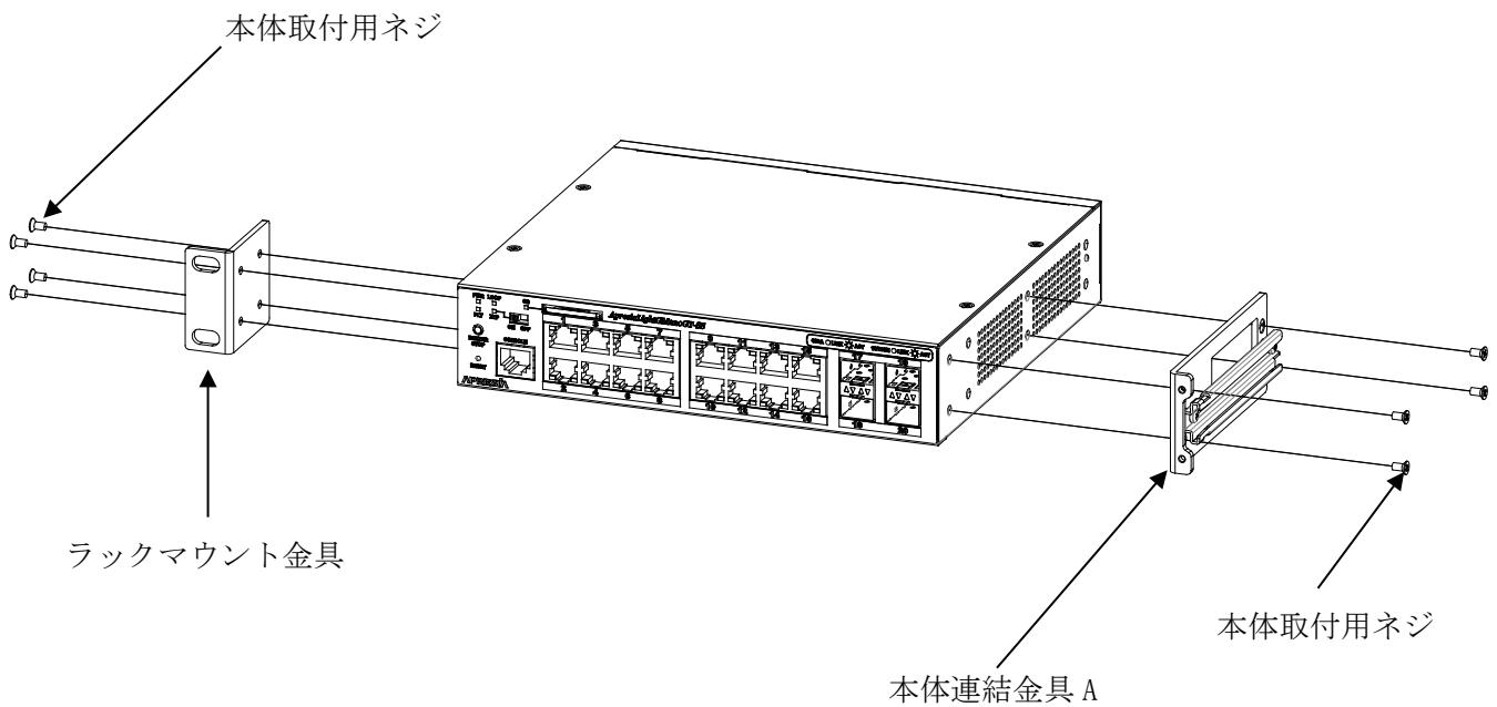
図 3-14 ラックマウント金具(2台連結用) (ALN-2P-RM01)の取り付け方法 1
