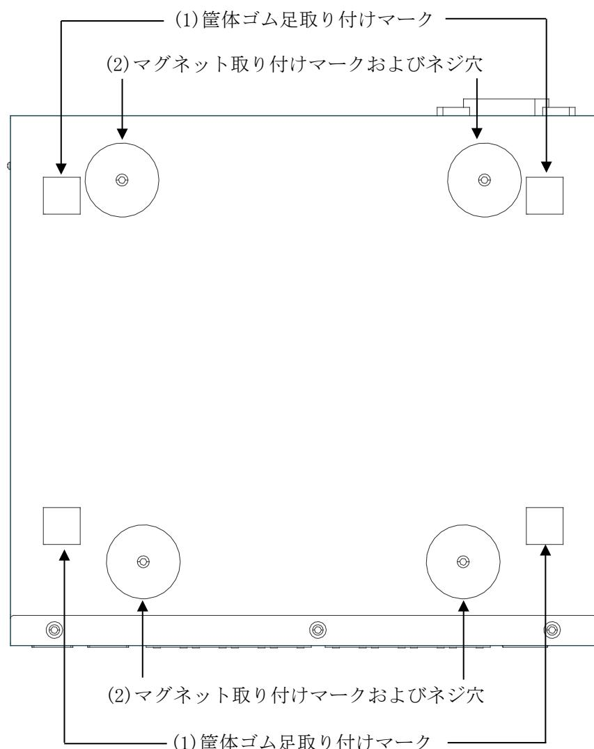
図 2-4 ApresiaLightGM212GT-SS のボトムパネルの構成
