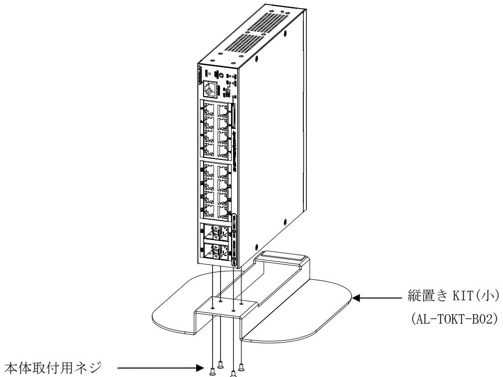
図 3-27 縦置き KIT(小) (AL-TOKT-B02) の取り付け方法
