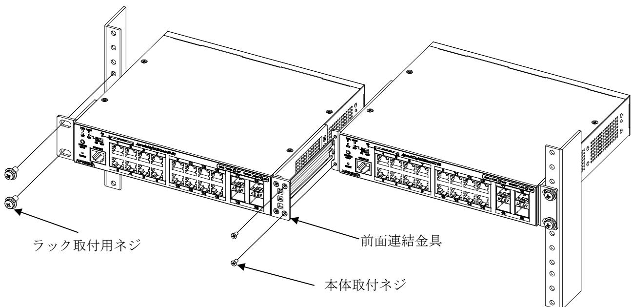
図 3-20 ラックマウント金具(2台連結用)(ALN-2P-RM01)使用時の取り外し方
