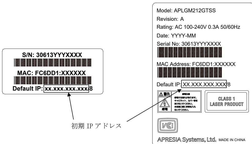
図 4-5 リアパネルおよびトップカバーの初期IPアドレスの表示位置
