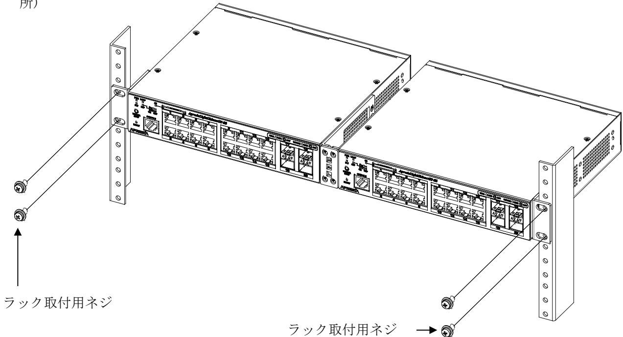
図 3-19 ラックマウント金具(2台連結用)(ALN-2P-RM01)の取り付け方法 6
