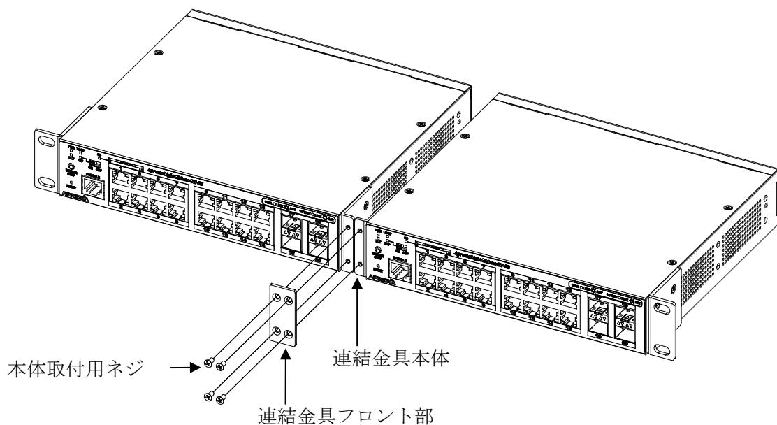
図 3-12 ラックマウント金具(2台連結用)の取り付け方法 3
