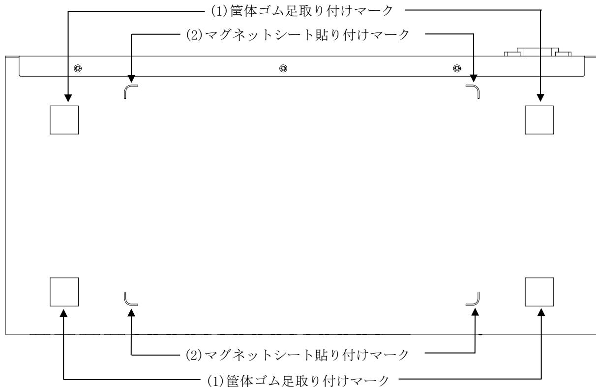
図 2-14 ApresiaLightGM228GT-SS のボトムパネルの構成
