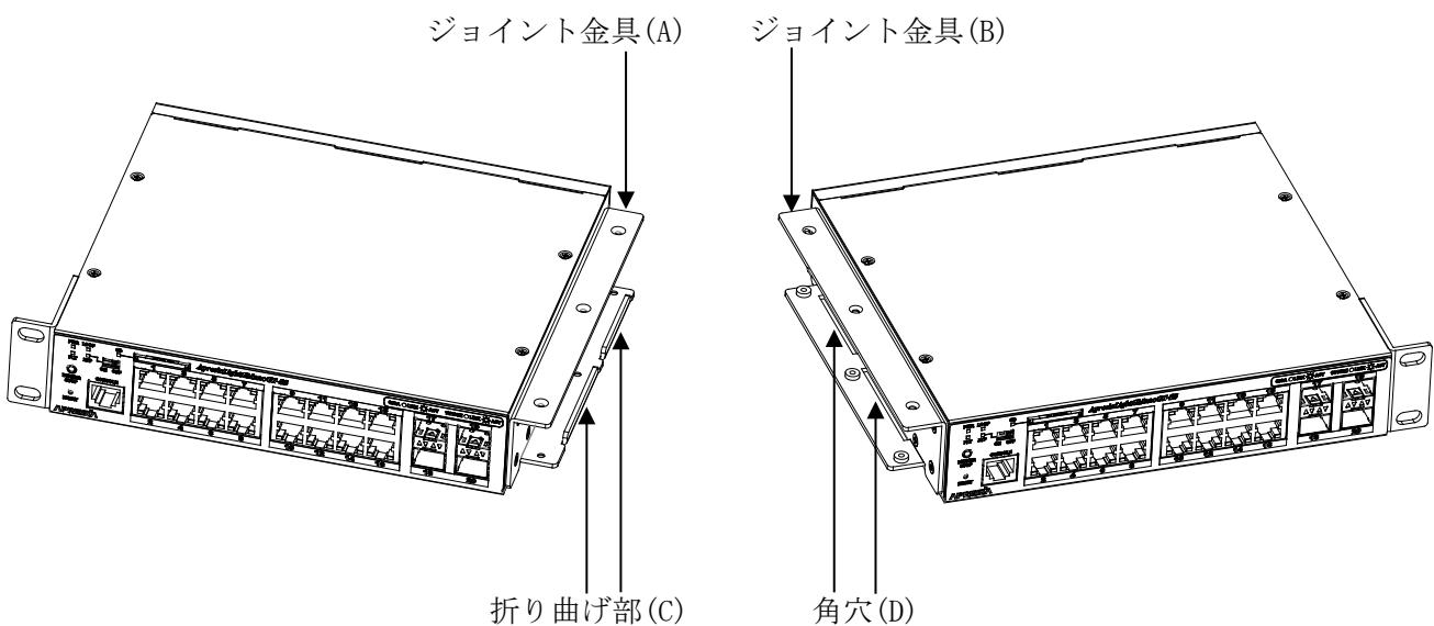
図 3-8 専用ラックマウント金具(2台連結用)の取り付け方法 3
