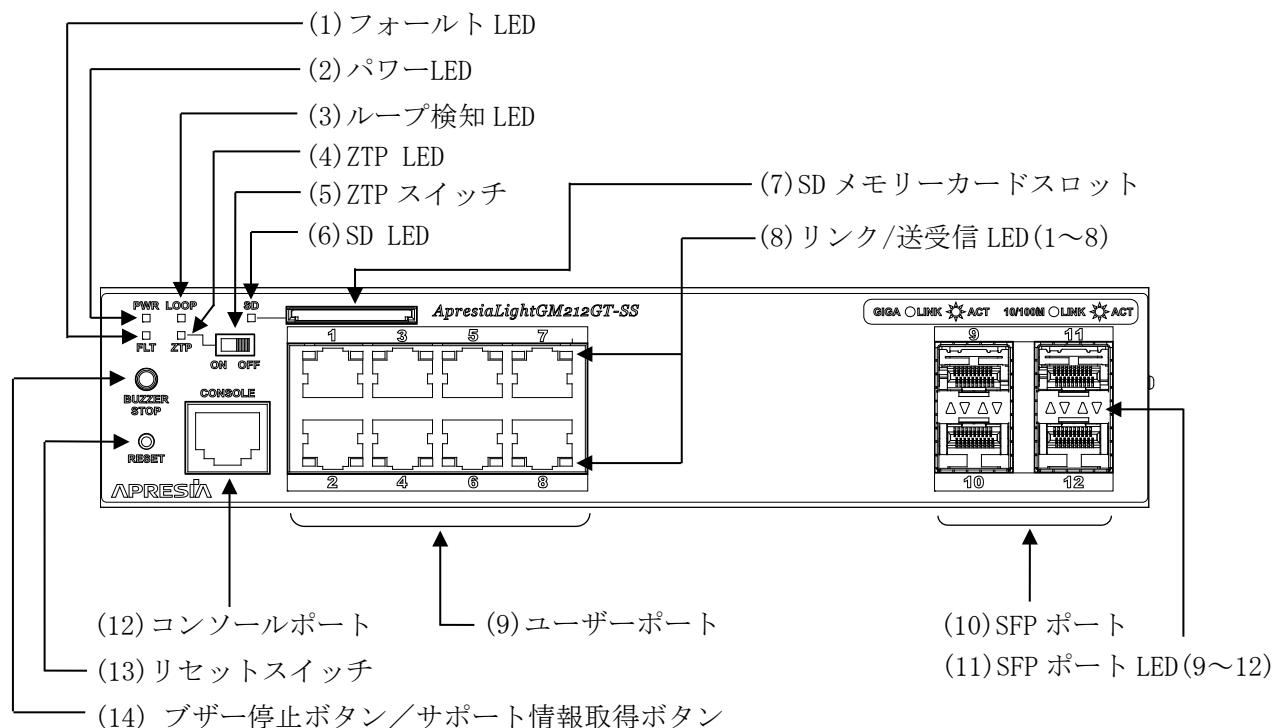
図 2-1 ApresiaLightGM212GT-SS のフロントパネルの構成
