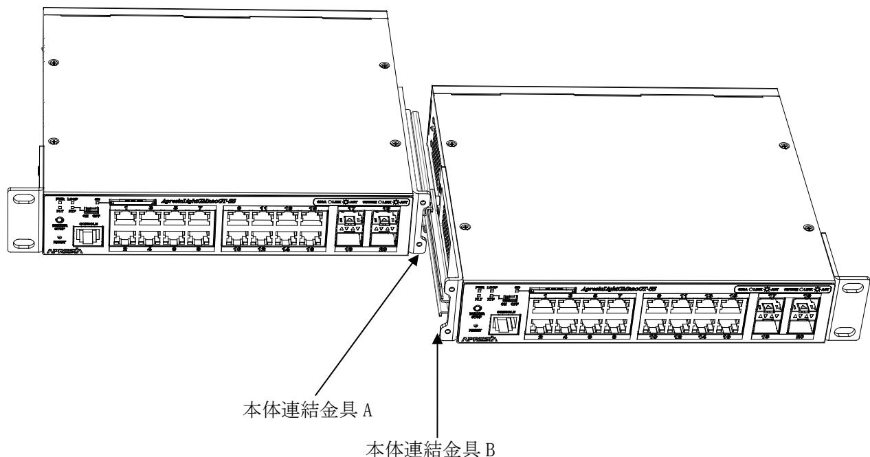
図 3-16 ラックマウント金具(2台連結用)(ALN-2P-RM01)の取り付け方法 3
