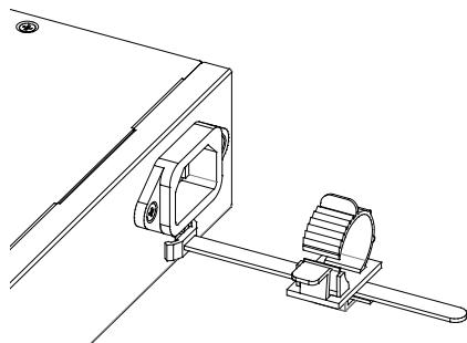
図 3-33 AC 電源コードストッパーの取り外し方法 1
