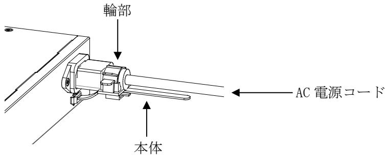
図 3-32 AC 電源コードストッパーの取り付け方法 3
