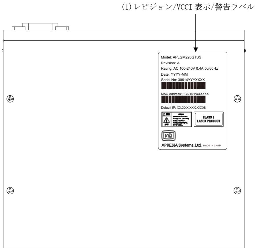
図 2-8 ApresiaLightGM220GT-SS のトップパネルの構成
