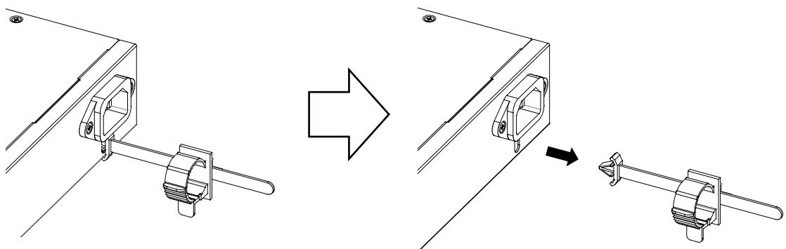
図 3-34 AC 電源コードストッパーの取り外し方法 2
