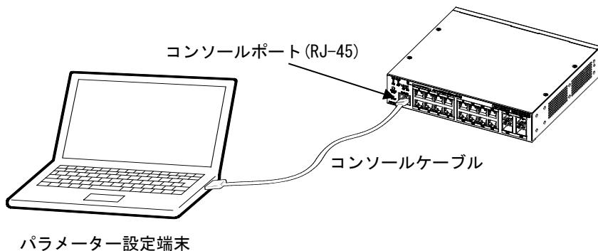
図 4-2 RS-232C ケーブルの接続
