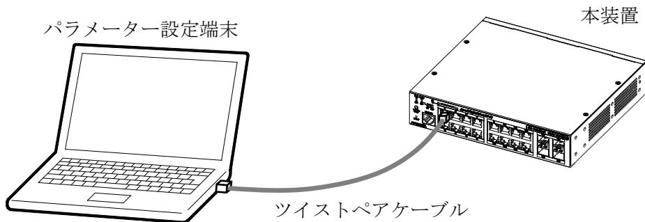
図 4-4 ツイストペアケーブルの接続例
