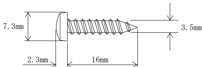
図 3-24 タッピングネジの寸法図
