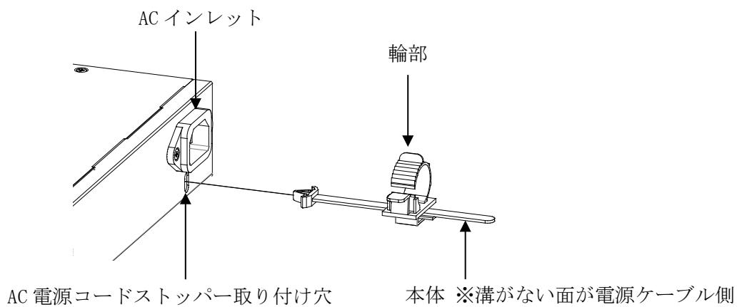
図 3-30 AC 電源コードストッパーの取り付け方法 1
