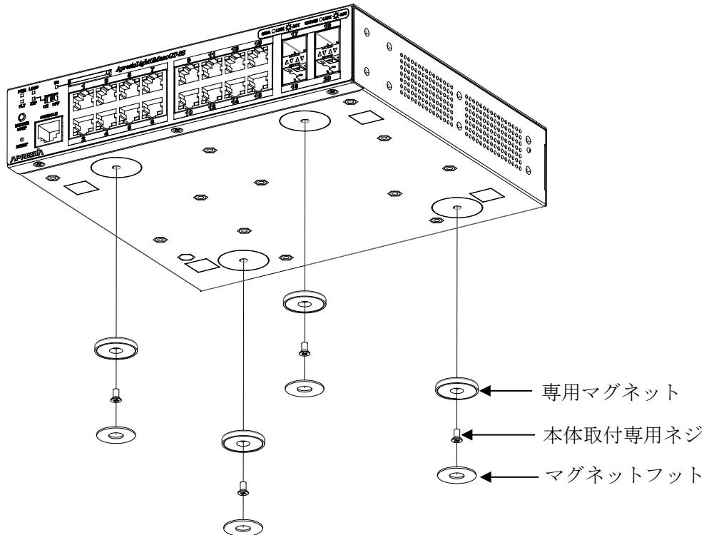
図 3-21 専用マグネットの取り付け方法
