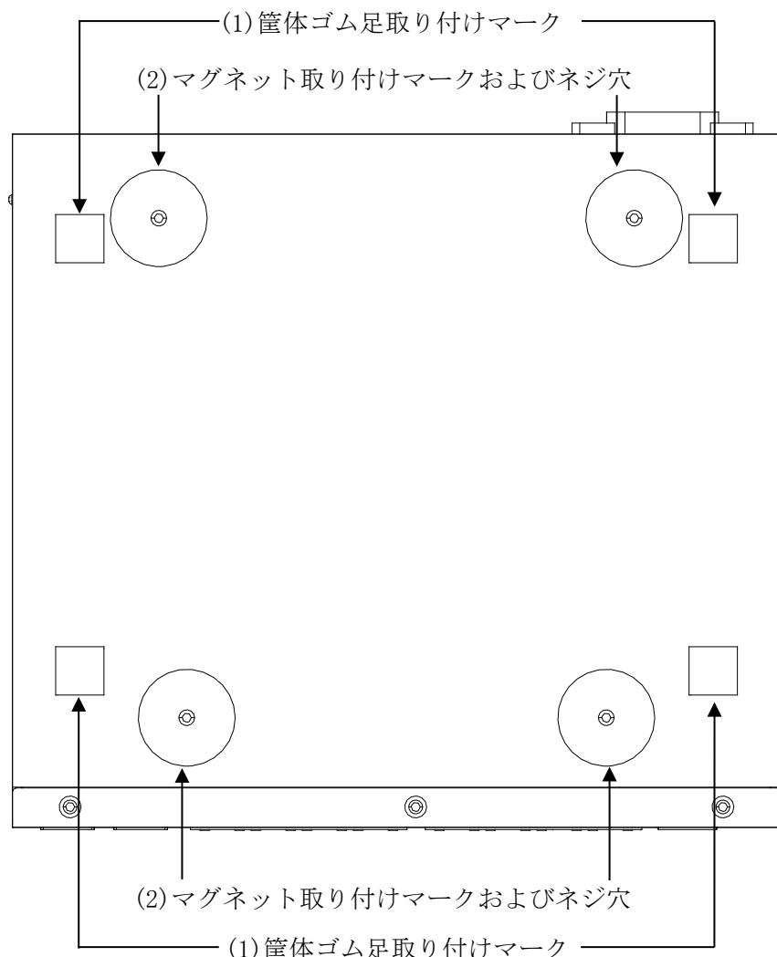
図 2-9 ApresiaLightGM220GT-SS のボトムパネルの構成
