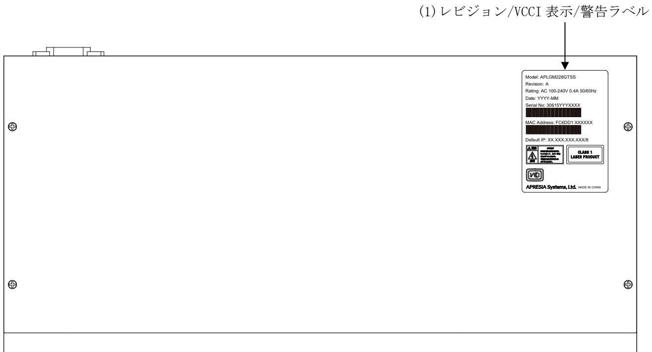
図 2-13 ApresiaLightGM228GT-SS のトップパネルの構成
