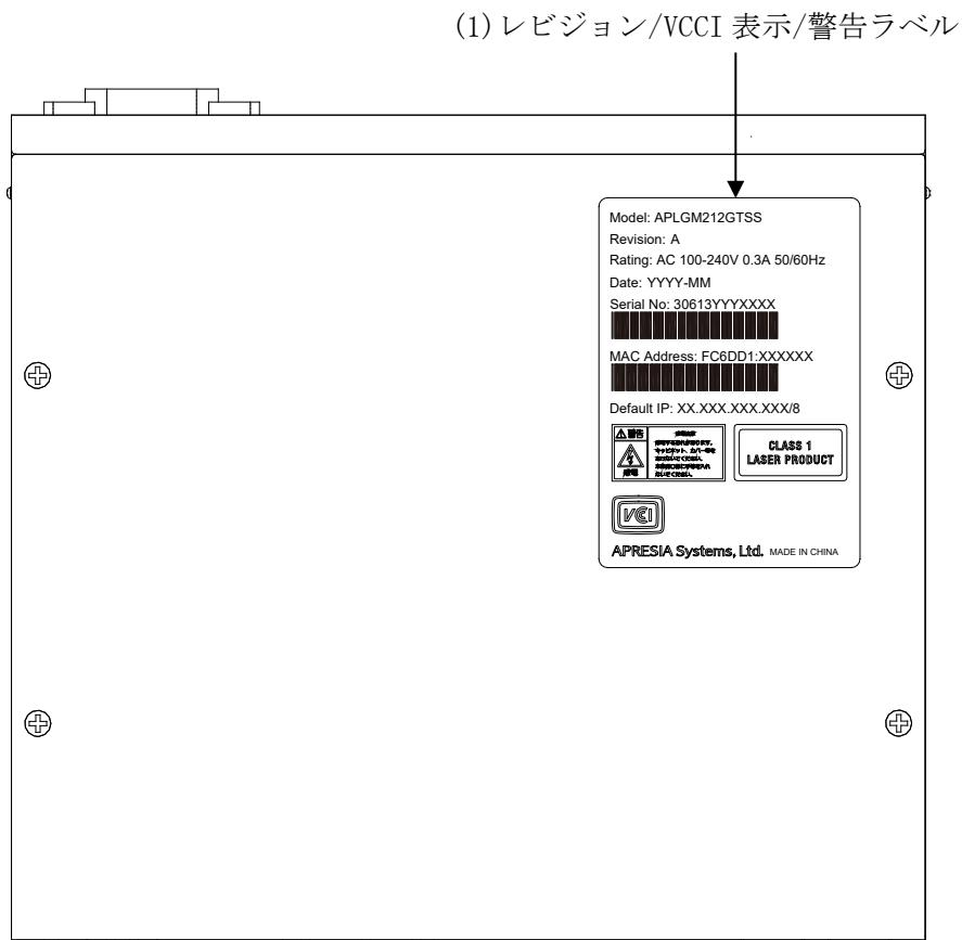
図 2-3 ApresiaLightGM212GT-SS のトップパネルの構成
