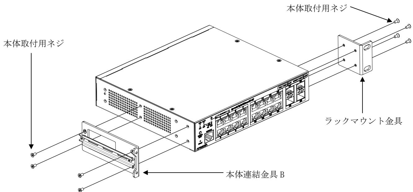
図 3-15 ラックマウント金具(2台連結用)(ALN-2P-RM01)の取り付け方法 2
