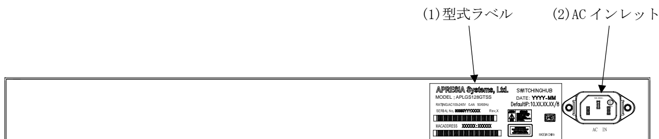
図 2-8 ApresiaLightGS128GT-SS のリアパネルの構成
