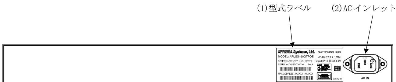
図 2-17 ApresiaLightGS120GT-PoE のリアパネルの構成
