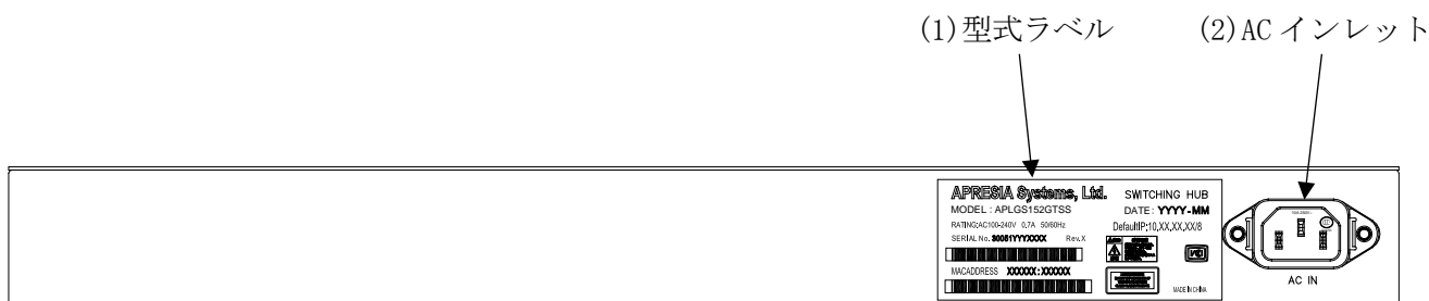
図 2-11 ApresiaLightGS152GT-SS のリアパネルの構成
