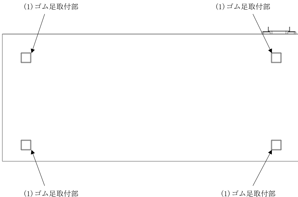
図 2-12 ApresiaLightGS152GT-SS のボトムパネルの構成
