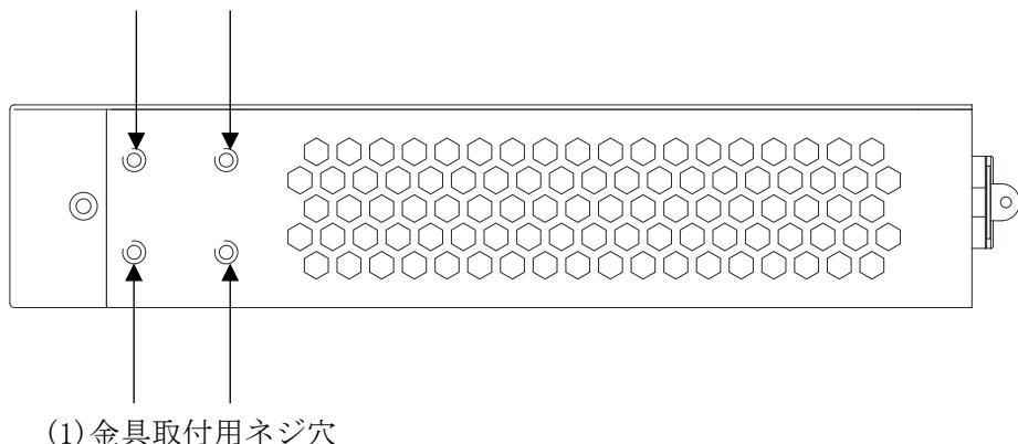
図 2-16 ApresiaLightGS152GT-SS のサイドパネルの構成
