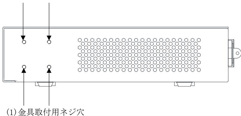
図 2-8 ApresiaLightGS120GT-SS のサイドパネルの構成
