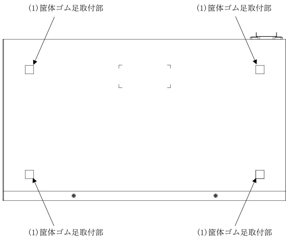
図 2-23 ApresiaLightGS120GT-PoE のボトムパネルの構成
