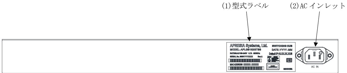
図 2-14 ApresiaLightGS152GT-SS のリアパネルの構成
