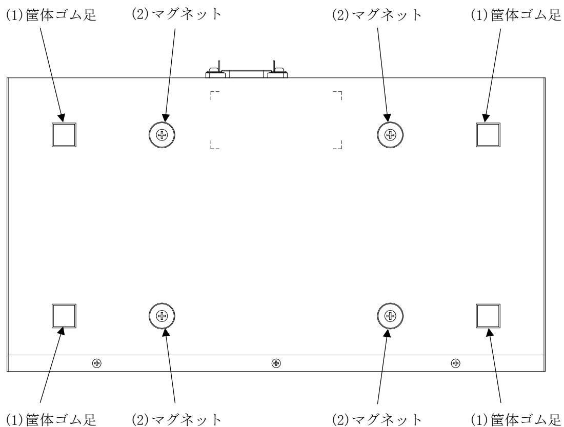
図 2-19 ApresiaLightGS110GT-PoE のボトムパネルの構成
