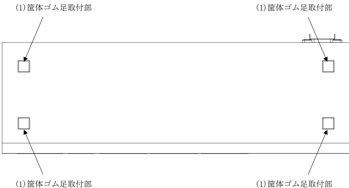
図 2-11 ApresiaLightGS128GT-SS のボトムパネルの構成
