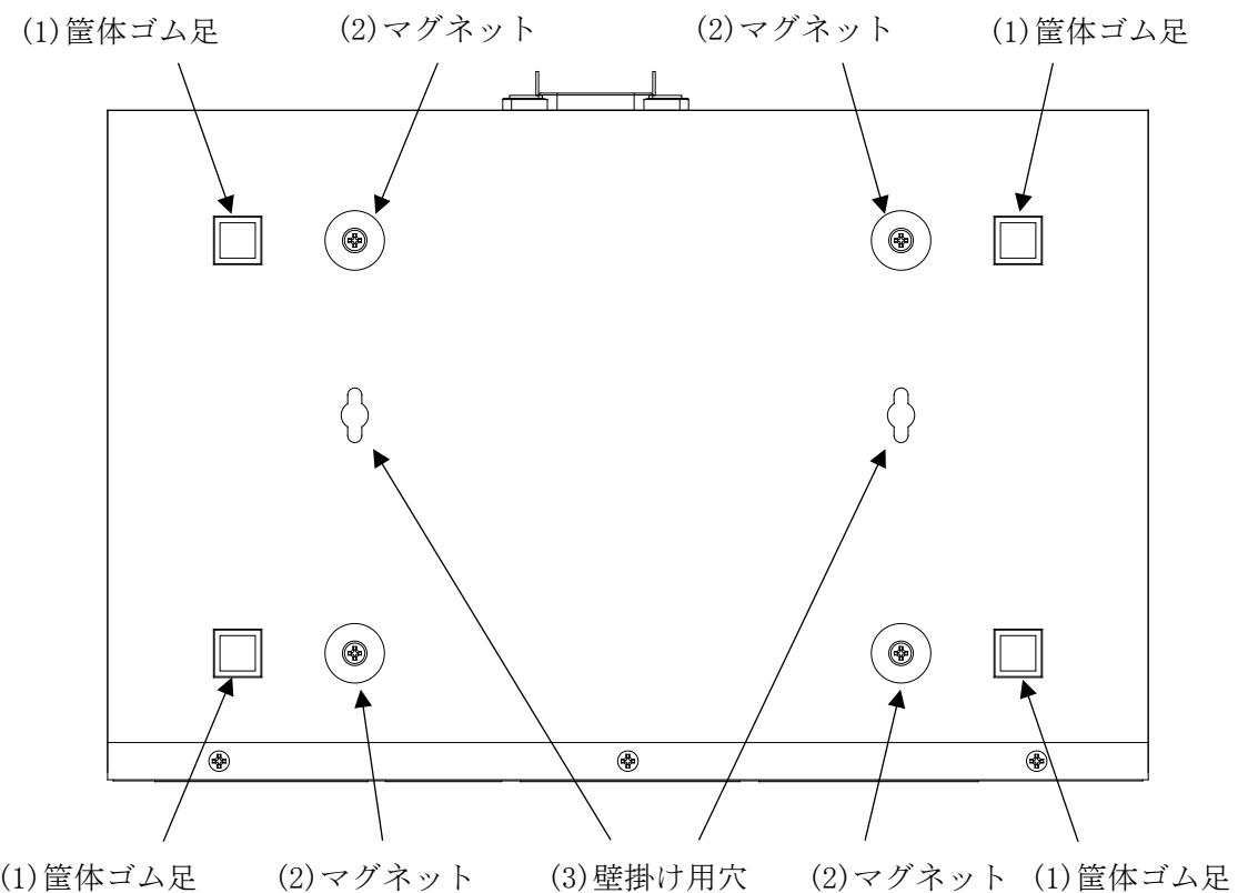
図 2-7 ApresiaLightGS120GT-SS のボトムパネルの構成
