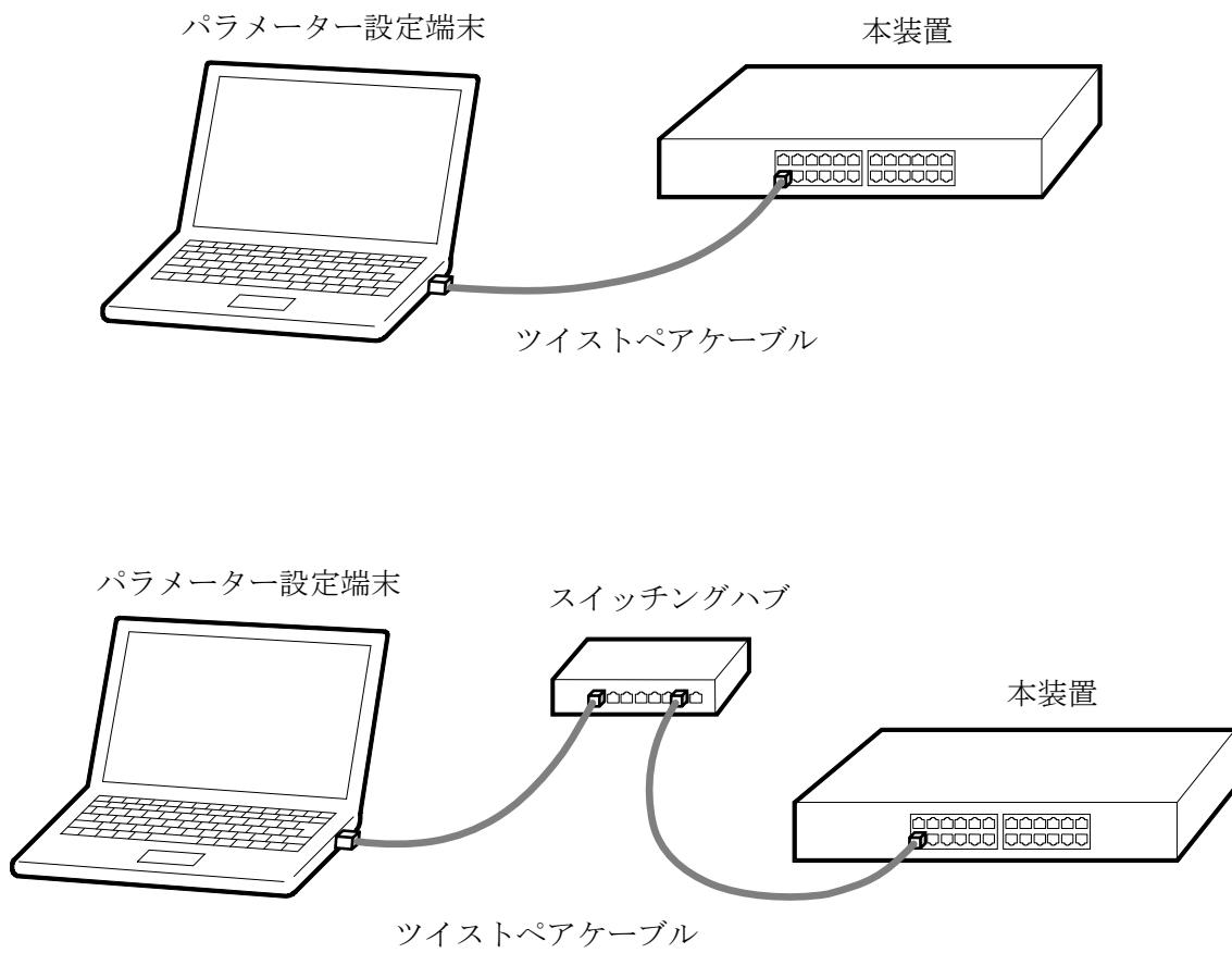
図 4-2 ツイストペアケーブルの接続例
