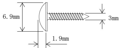
図 3-6 ト拉斯小ネジの寸法図
