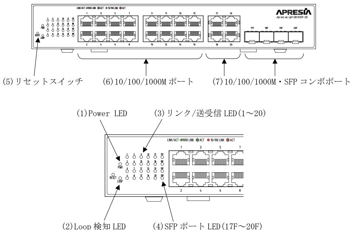
図 2-5 ApresiaLightGS120GT-SS のフロントパネルの構成
