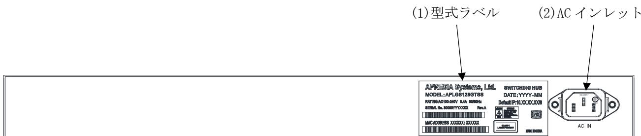
図 2-10 ApresiaLightGS128GT-SS のリアパネルの構成
