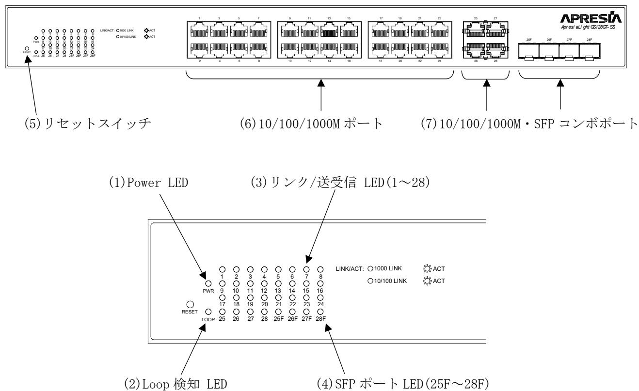
図 2-9 ApresiaLightGS128GT-SS のフロントパネルの構成
