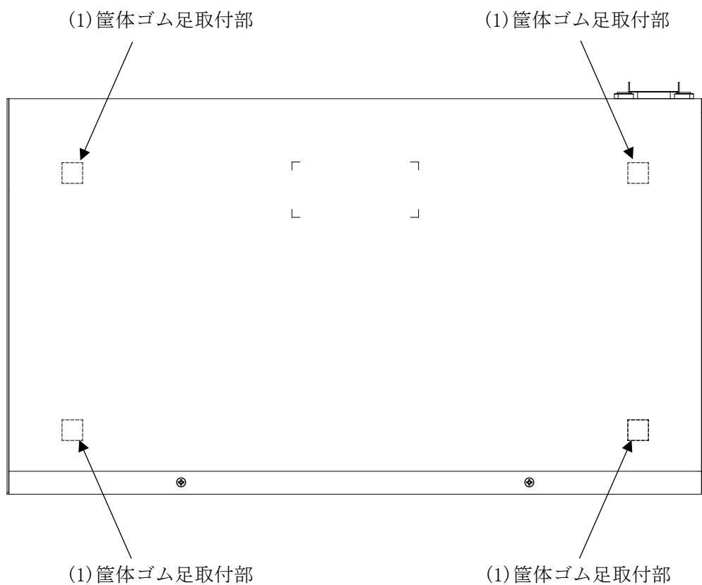
図 2-27 ApresiaLightGS128GT-PoE のボトムパネルの構成
