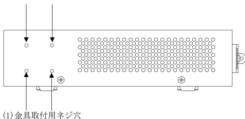
図 2-4 ApresiaLightGS110GT-SS のサイドパネルの構成
