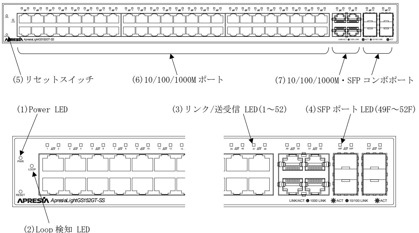
図 2-13 ApresiaLightGS152GT-SS のフロントパネルの構成
