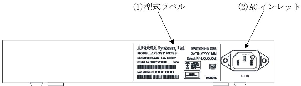
図 2-2 ApresiaLightGS110GT-SS のリアパネルの構成
