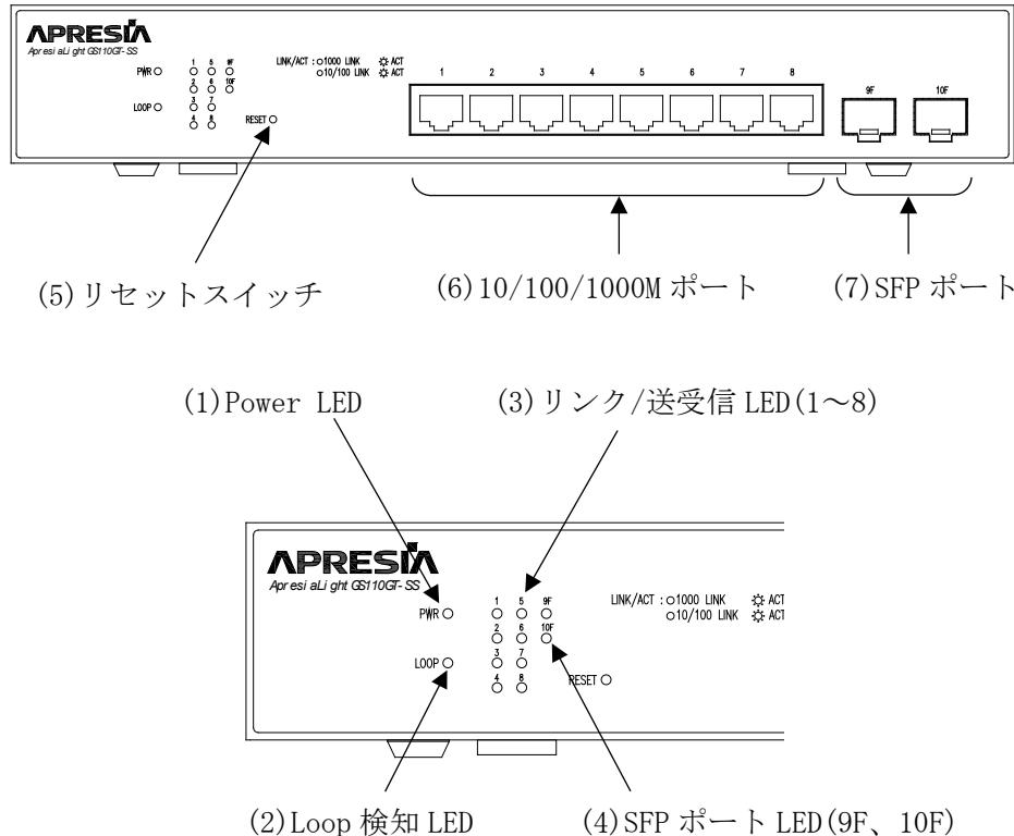
図 2-1 ApresiaLightGS110GT-SS のフロントパネルの構成
