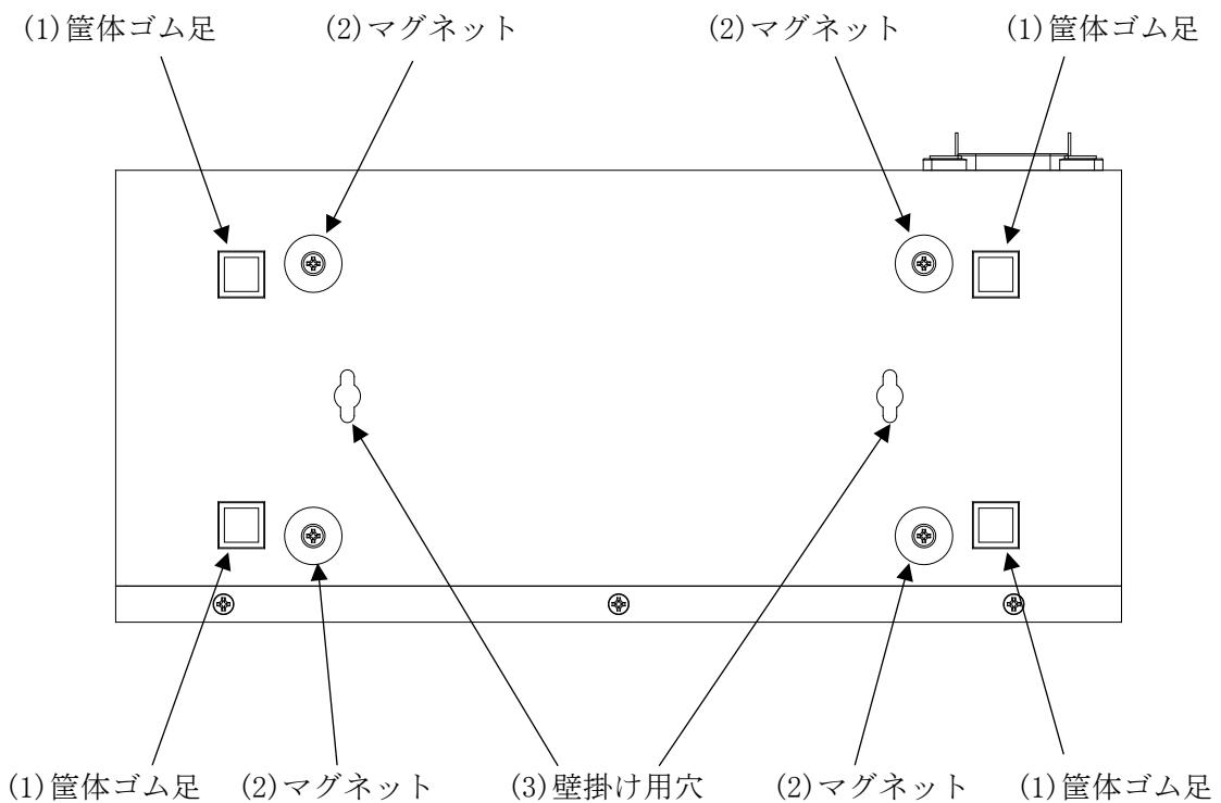
図 2-3 ApresiaLightGS110GT-SS のボトムパネルの構成
