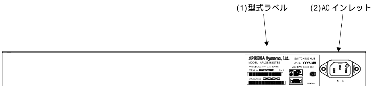
図 2-14 AprasiaLightGS152GT-SS のリアパネルの構成
