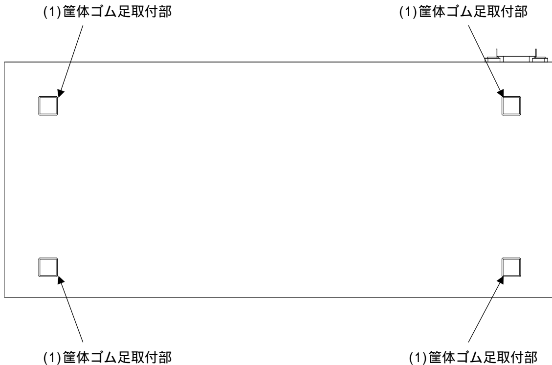
図 2-15 ApresiaLightGS152GT-SS のボトムパネルの構成
