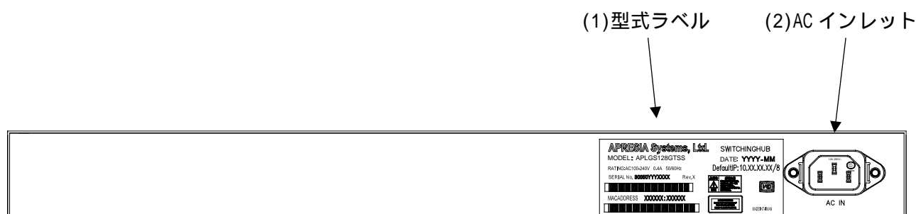
図 2-10 ApresiaLightGS128GT-SS のリアパネルの構成
