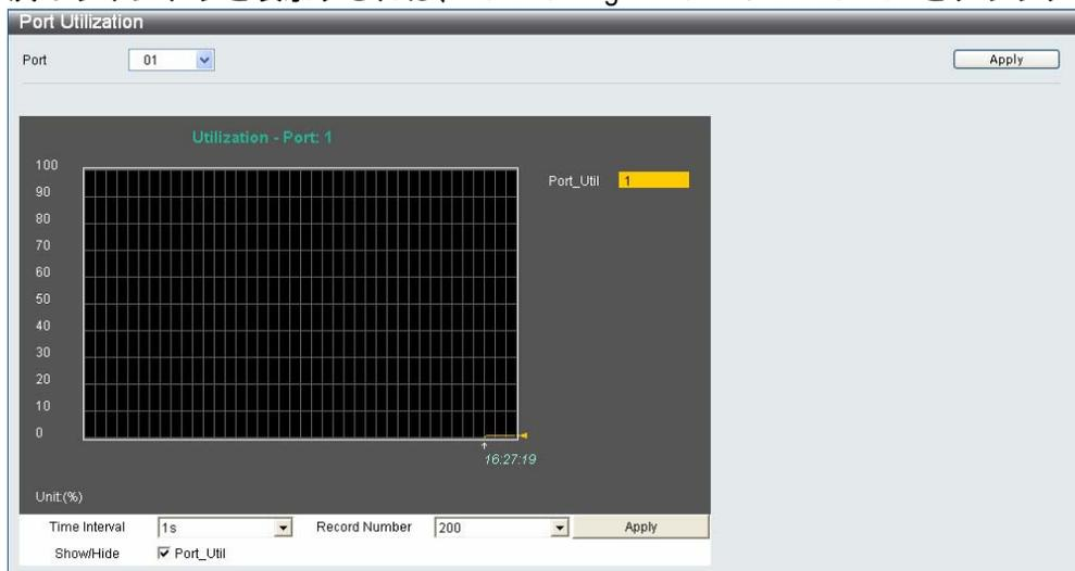
ポートプルダウンメニューを使って、統計を表示するポートを選択します。ポートをクリックして、GUI 画面の一番上にあるスイッチのリアルタイムグラフィックを使用することもできます。
