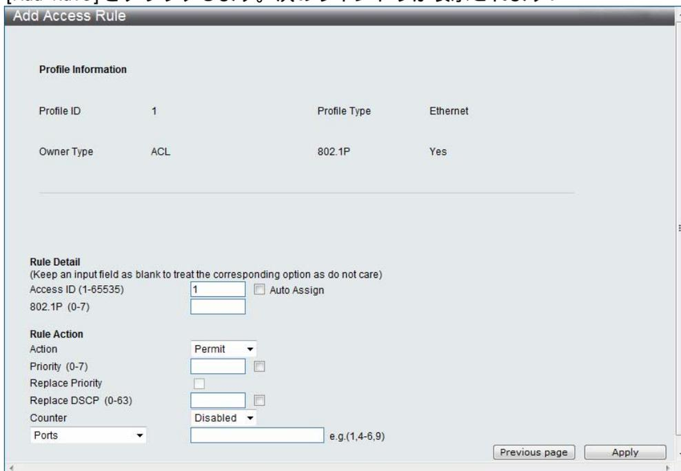
イーサネット用のアクセス規則を設定するには、次のパラメーターを調整して、[Apply]をクリックします。下記にパラメーターの説明を記載します。
