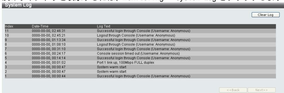
スイッチのログにはイベント情報を記録することができます。[Next]をクリックして、[System Log] ウィンドウの次のページへ移動します。[Clear log]をクリックして、スイッチ履歴ログを消去できます。
