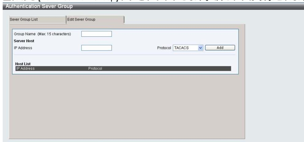
一覧に認証サーバーを追加するには、IP アドレスフィールドに認証サーバーの IP アドレスを入力し、認証サーバーの IP アドレスに関連するプロトコルを選択して、[Add]をクリックします。これで、この認証サーバーがグループに追加されます。
