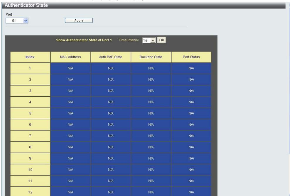
このウィンドウには、選択したデバイス上の各ポートのオーセンティケータ状態が表示されます。ウィンドウの一番上にあるプルダウンメニューを使い、[OK]をクリックして、ポール間隔を 1 ~ 60 秒に設定できます。
