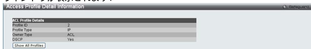
[Access Profile List]ウィンドウに戻るには、[Show All Profiles]をクリックします。事前に設定したエントリーに規則を追加するには、対応する[Add/View Rules]をクリックして、[Access Rule List]ウィンドウにある[Add Rule]をクリックします。次のウィンドウが表示されます：
