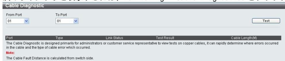
テストするポートの範囲を入力して、[Test]をクリックします。このウィンドウの下半分にあるテーブルに、結果が表示されます。なお、ケーブル長については参考値としてください。
