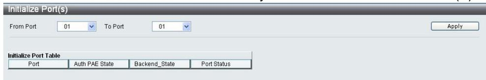
このウィンドウで、ポート、または、ポートのグループを初期化できます。ウィンドウの下半分にあるポートの初期化テーブルに、ポートの現在の状態が表示されます。ポートを初期化するには、最初のポートフィールドと最後のポートフィールドで、ポートの範囲を選択します。初期化を開始するには、[Apply]をクリックします。
