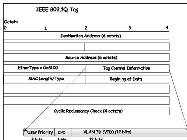
イーサタイプと VLAN ID は MAC 送信元アドレスの後、元のイーサタイプ/長さ、または、論理リンク制御の前に挿入します。パケットは元の長さよりも 1 バイト長いので、巡回冗長検査(CRC)を再計算する必要があります。
