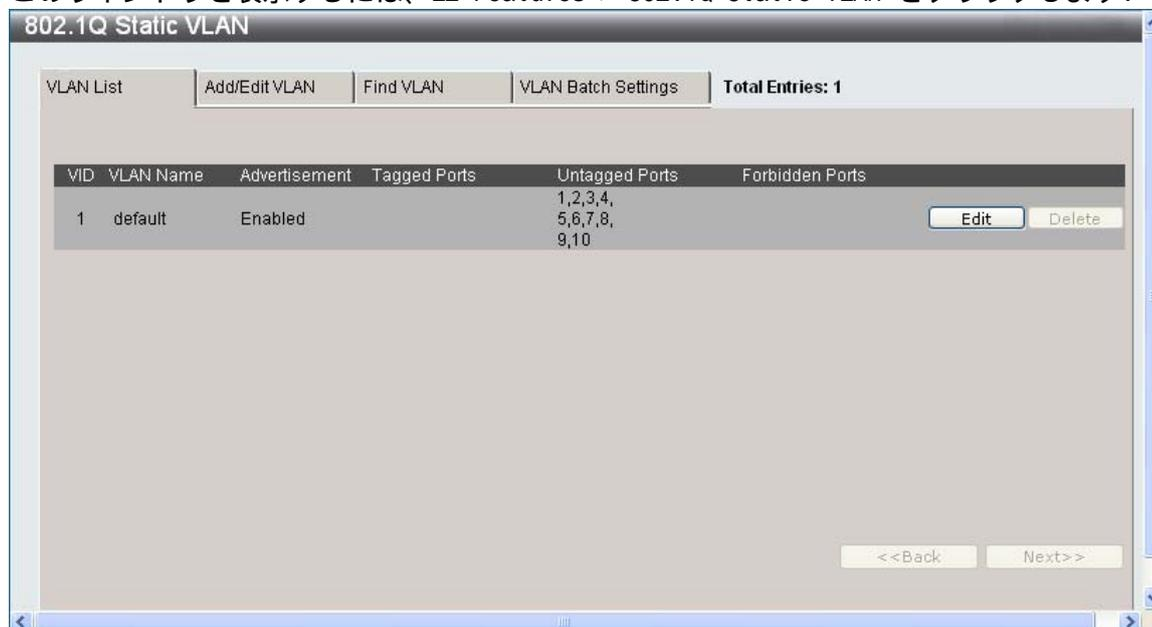
新しい 802.1Q VLAN エントリーを作成するには、ウィンドウの一番上にある [Add/Edit VLAN] タブをクリックします。次のページの最初の図にあるように、新しいタブが表示されます。ここで、ポートを設定して、新しい VLAN に固有名と番号を割り当てます。
