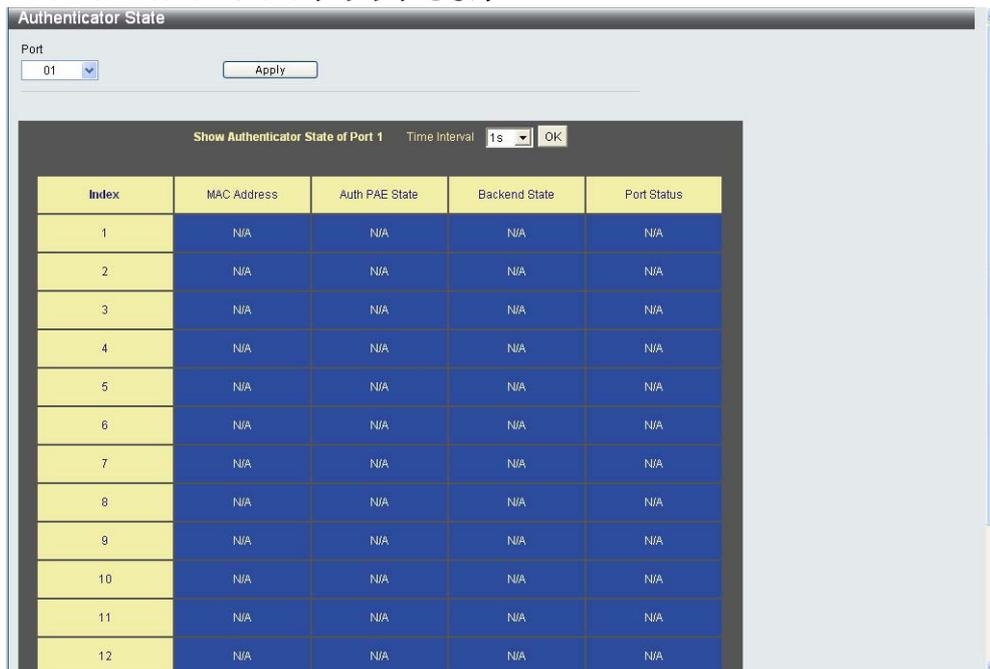
このウィンドウには、選択したデバイス上の各ポートのオーセンティケータ状態が表示されます。ウィンドウの一番上にあるプルダウンメニューを使い、[OK]をクリックして、ポーリング間隔を 1 ~ 60 秒に設定できます。
