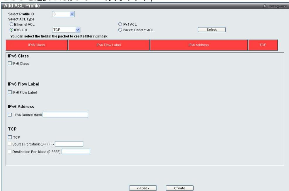
ウィンドウの一番上にあるボックスをクリックします。ボックスの色が赤に変わり、設定用のパラメーターが表示されます。新しいエントリーを追加するには、正しい情報を入力して、[Create]をクリックします。[Access Profile List]ウィンドウに戻るには、[<<Back]をクリックします。
