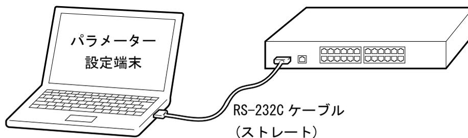
図 1-1 RS-232C ケーブルの接続
