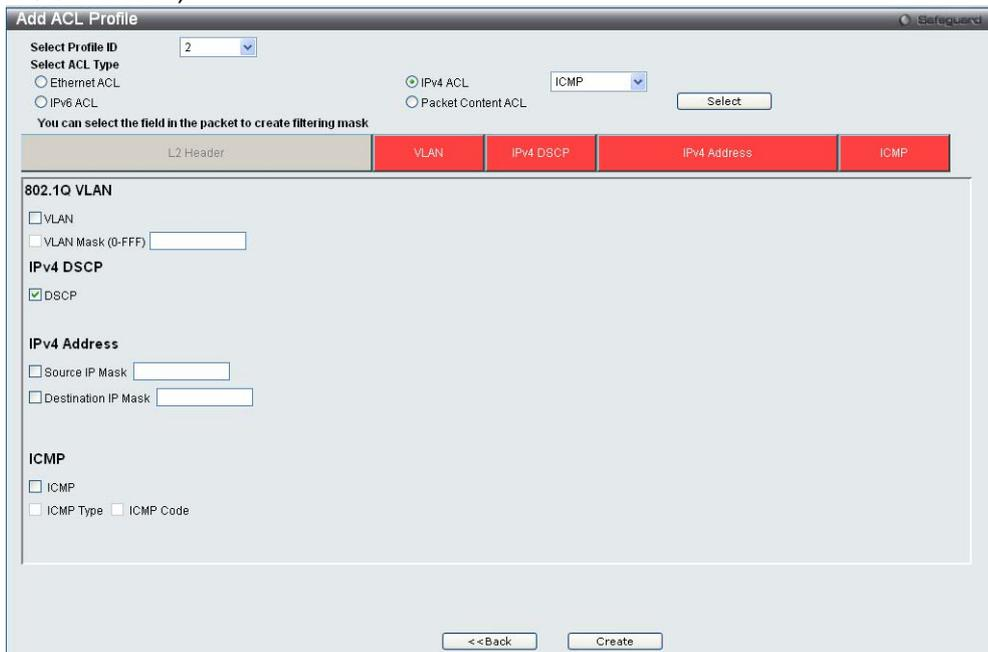
ウィンドウの一番上近くにあるボックスをクリックします。ボックスの色が赤に変わり、構成用のパラメーターが表示されます。新しいエントリーを追加するには、正しい情報を入力して、[Create]をクリックします。[Access Profile List]ウィンドウに戻るには、[<<Back]をクリックします。
