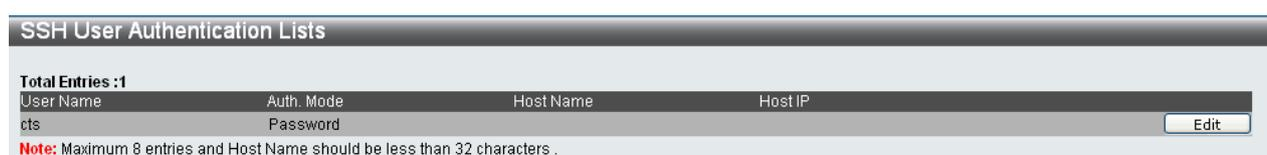
上の例では、[Configuration]フォルダにある[User Accounts]ウィンドウを使って、ユーザーアカウント「adpro」を設定しています。SSH ユーザー用のパラメーターを設定するには、事前にユーザーアカウントを設定する必要があります。SSH ユーザー用のパラメーターを編集するには、対応する[Edit]をクリックします。次のウィンドウが表示されます。このウィンドウで構成を行います：
