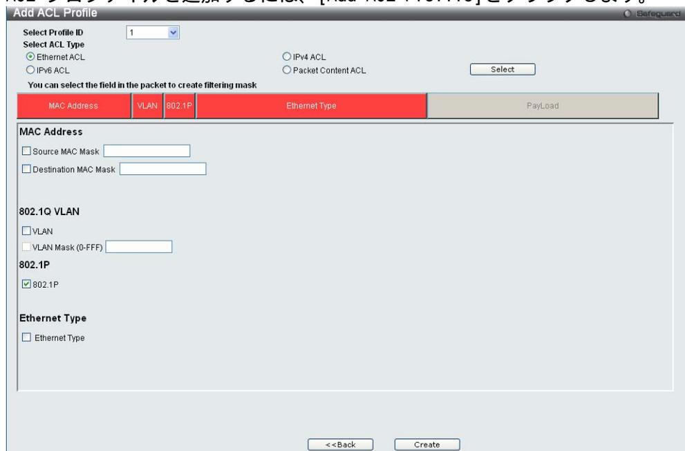
アクセスプロファイル構成ウィンドウには4つのセットがあります。イーサネット(または、MAC アドレスベース)プロファイル用、IP(IPv4)アドレスベースプロファイル用、パケット内容用、および、IPv6 用の4つのセットです。これら4つのアクセスプロファイルオプションの詳細情報を表示するには、プルダウンメニューを使って1~512のプロファイルIDを選択し(この例では1が選択されています)、ラジオボタンを使ってACLタイプを選択(この例では、Ethernet ACL が選択されています)した後、[Select]をクリックします。次に、ウィンドウの一番上近くにあるボックスをクリックします。ボックスの色が赤に変わり、設定用のパラメーターが表示されます(この例では、MAC アドレス、802.1Q VLAN、802.1p、および、イーサネットタイプが選択されています)。[Create]をクリックする前に、最低1つのマスクを選択します(この例では、802.1p にチェックが入っています)。[Access Profile List]ウィンドウに戻るには、[<<Back]をクリックします。
