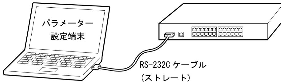
図 1-1 RS-232C ケーブルの接続
