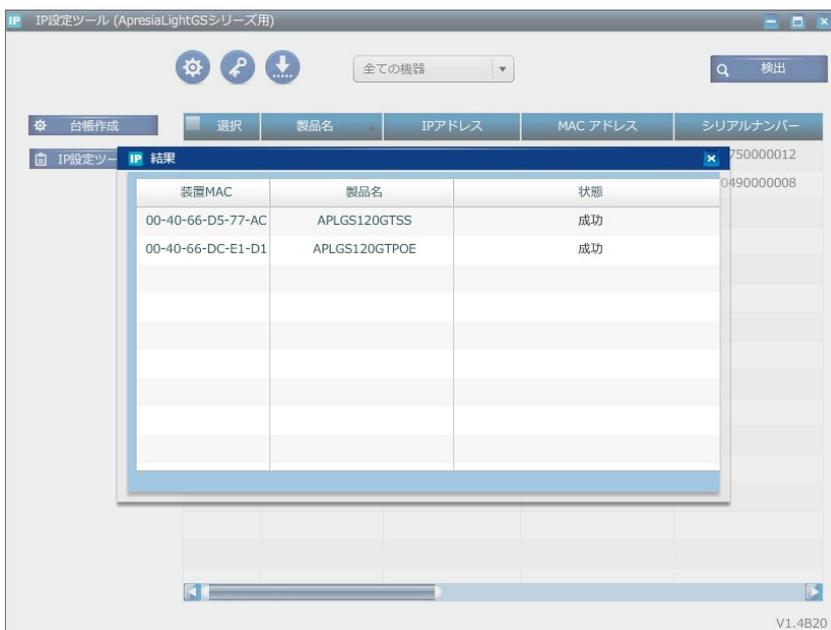
出現した画面の一覧で、状態が [成功] と表示された機器はパスワード変更が正常に行われています。
